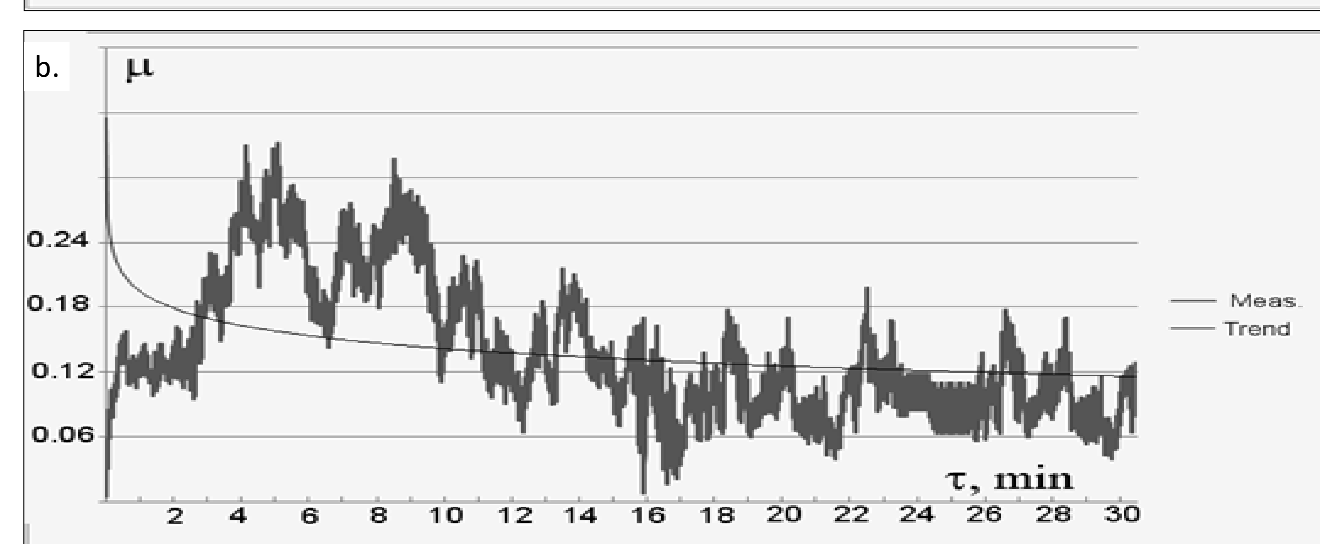
Fig. 6. Współczynnik tarcia kompozytu o zbrojeniu hybrydowym: kompozyt bez węgla szklistego (a), kompozyt z węglem szklistym.
