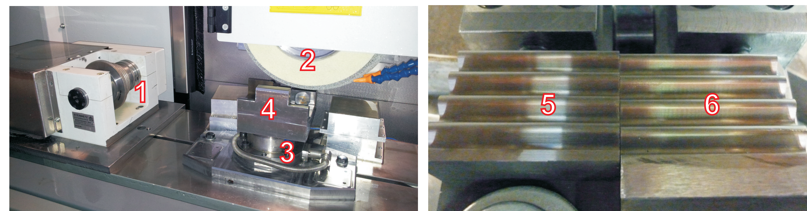
Rys. 1. Widok stanowiska badawczego: 1) rolka obciążająca, 2) ściernica, 3) siłomierz, 4) uchwyt, 5) przedmiot obrabiany, 6) przewodnica chłodziwa. Fig. 1. Set-up view: 1) profile dresser, 2) grinding wheel, 3) dynamometer, 4) workpiece chuck, 5) workpiece, 6) coolant guide
