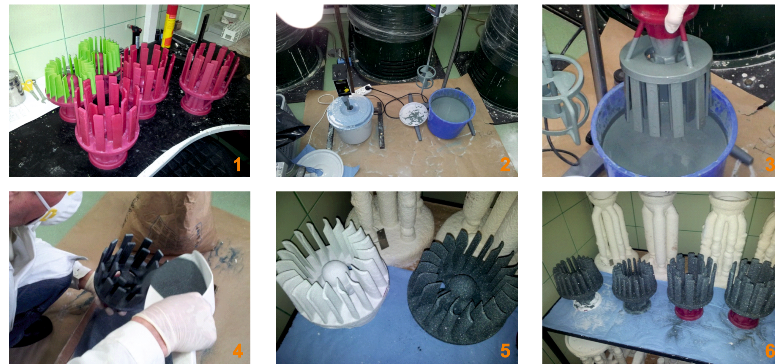
Formowanie zestawów modelowych: (1) model woskowy, (2) mieszanka na warstwy nośne formy (backup), (3) nanoszenie pierwszej warstwy, (4) obsypywanie, (5) formy, (6) badanie kinetyki suszenia form Forming of model sets: (1) a wax pattern, (2) compound for the backup, (3) depositing a first layer (4) covering, (5) shell moulds, (6) investigation of kinetics of mould drying
