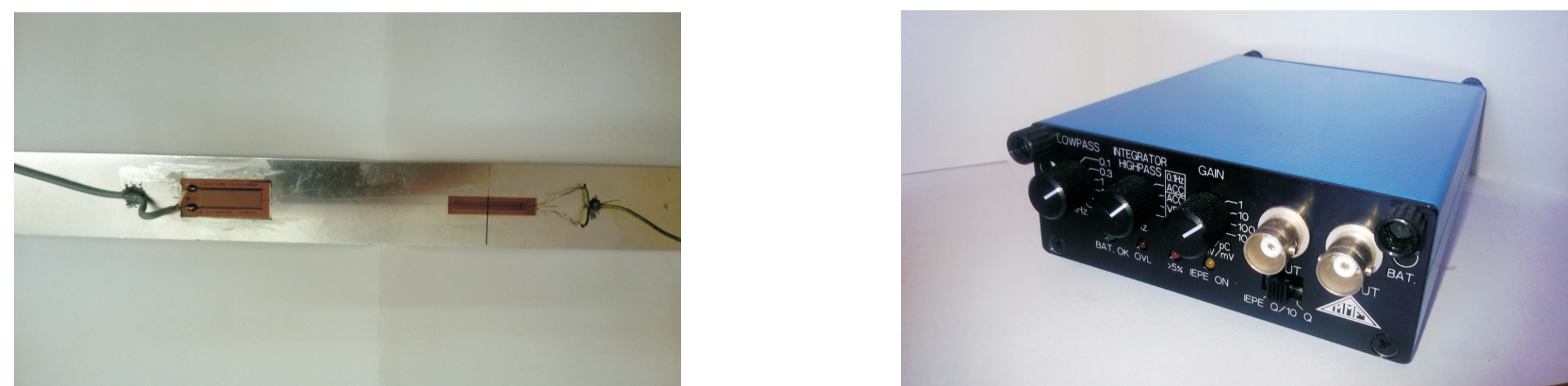
Rys.1. Badana próbka oraz użyty wzmacniacz ładunku piezoelektrycznego Fig.1. The sample and used the piezoelectric charge amplifier
