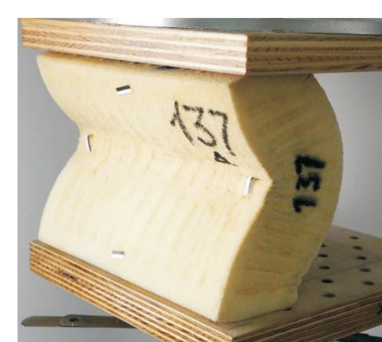
Rys.6. Kształtka pianki ulegająca wyboczeniu na dotychczasowym stanowisku i pomiar na nowym stanowisku Fig.6. Foam sample showing buckling in the old test stand and foam mounted in the new test stand for horizontal measurements
