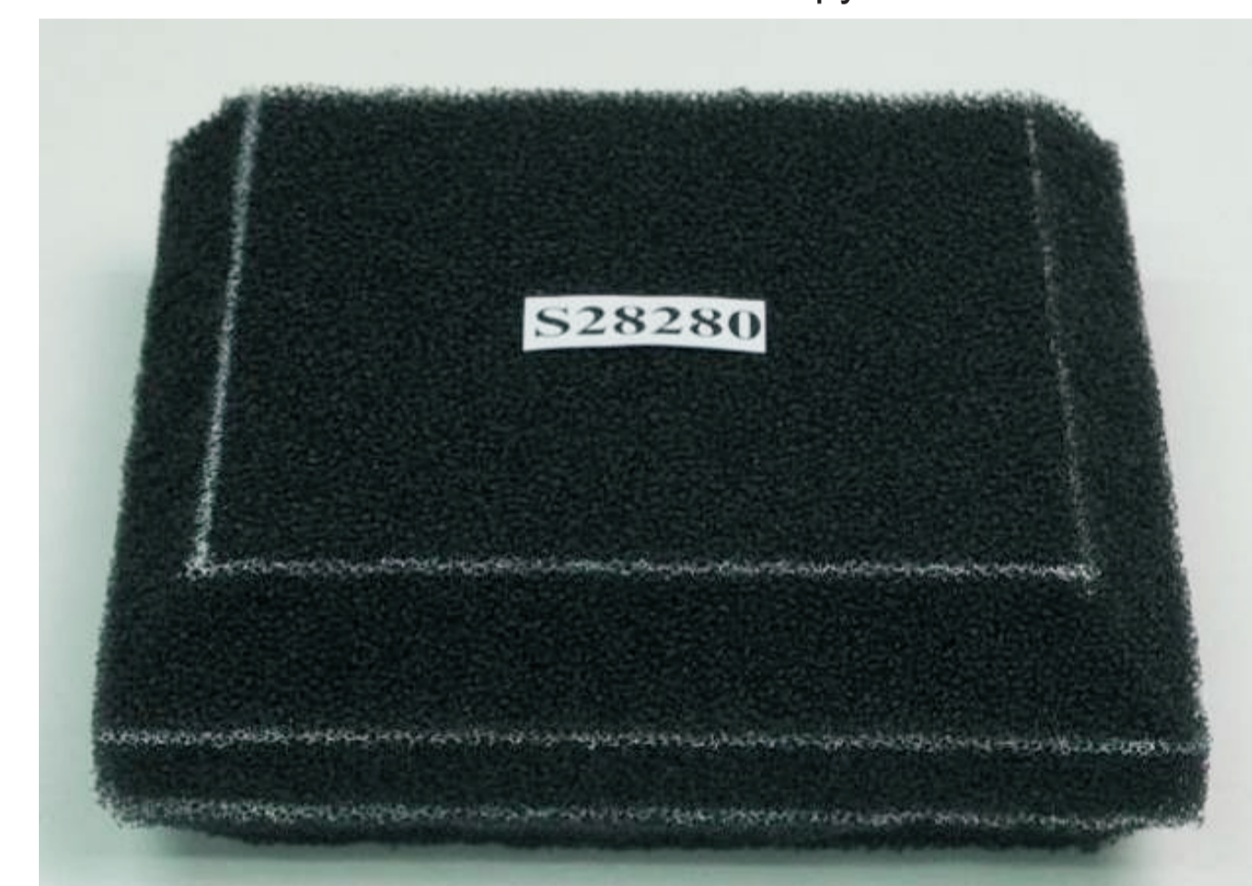
Rys.2. Kształtka w formie podwójnego odwróconego ściętego ostrosłupa o podstawie kwadratu z kołnierzem Fig.2. Foam in a form of double reversed cut pyramid with collar
