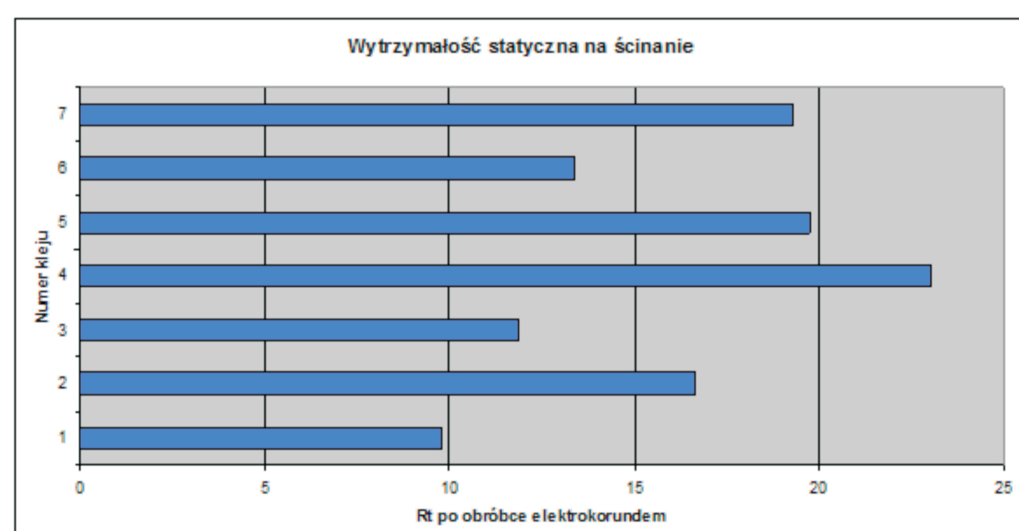
Rys. Wyniki selekcji klejów - najlepszy wariant - ok. 23 MPa dla ARALDIT 2011(nr 4) Fig. The results of glue selection - the best variant - app. 23 MPa for ARALDIT 2011 (No 4)
