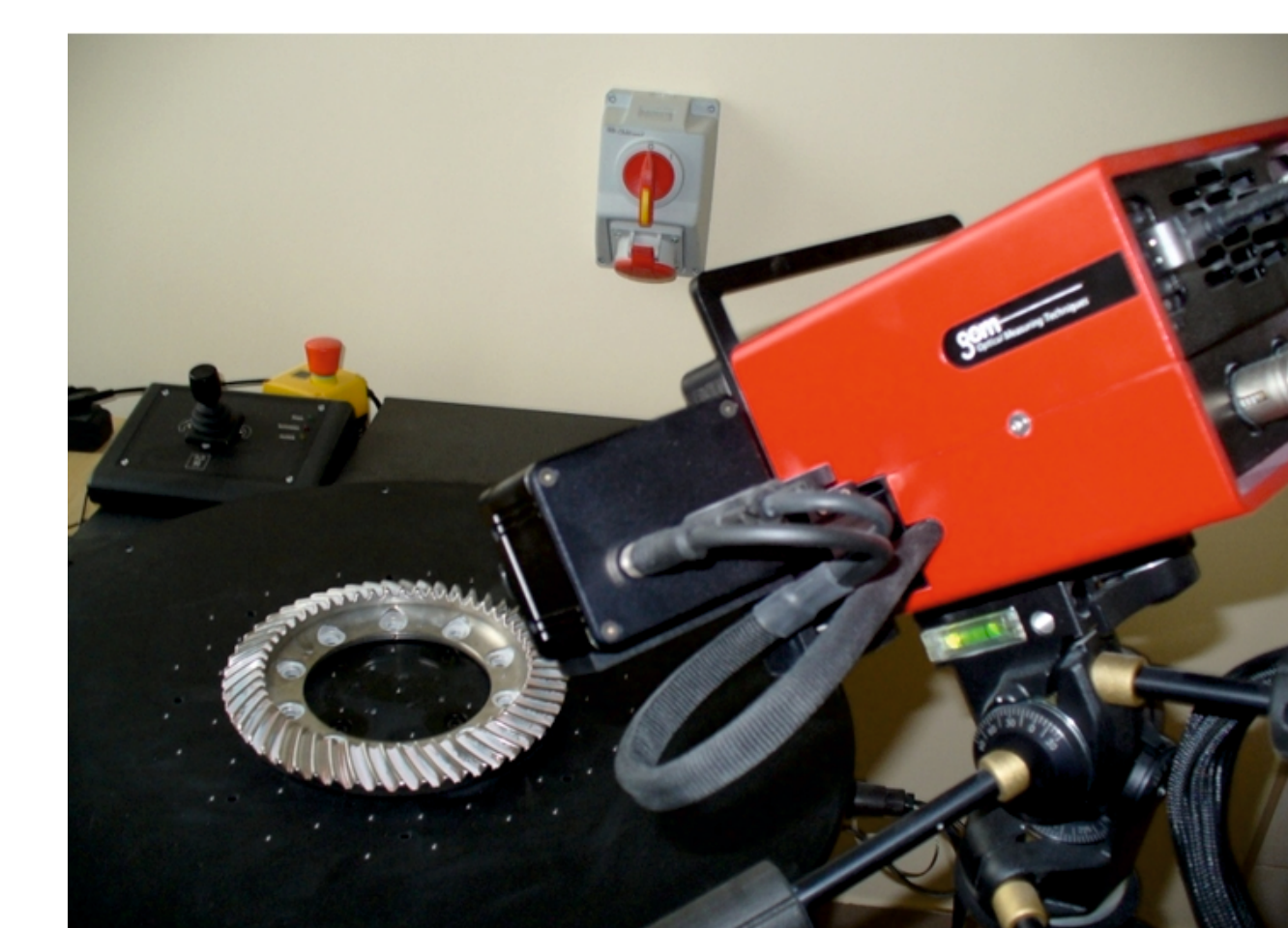
Rys. 10 Pomiar koła skanerem ATOS I (światło białe) Fig. 10 Measuring of gear with ATOS I scanner using (white light)
