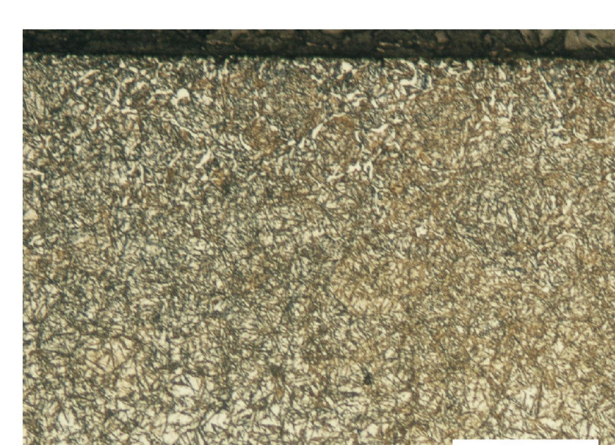
Rysunek 5d. Struktura warstwy przypowierzchniowej po obróbce (proces 2). Widoczny martenzyt, austenit szczątkowy bez wydzielenia węglików po granicach ziaren. Figure 5d. Structure of the near surface area after treatment (process 2): martensite+retained austenite, without carbides precipitations
