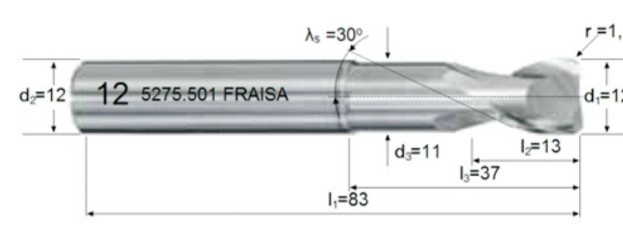
Rys.1. Widok i wymiary narzędzia zastosowanego w badaniach Fig.1. The view and the tool dimensions used in the study
