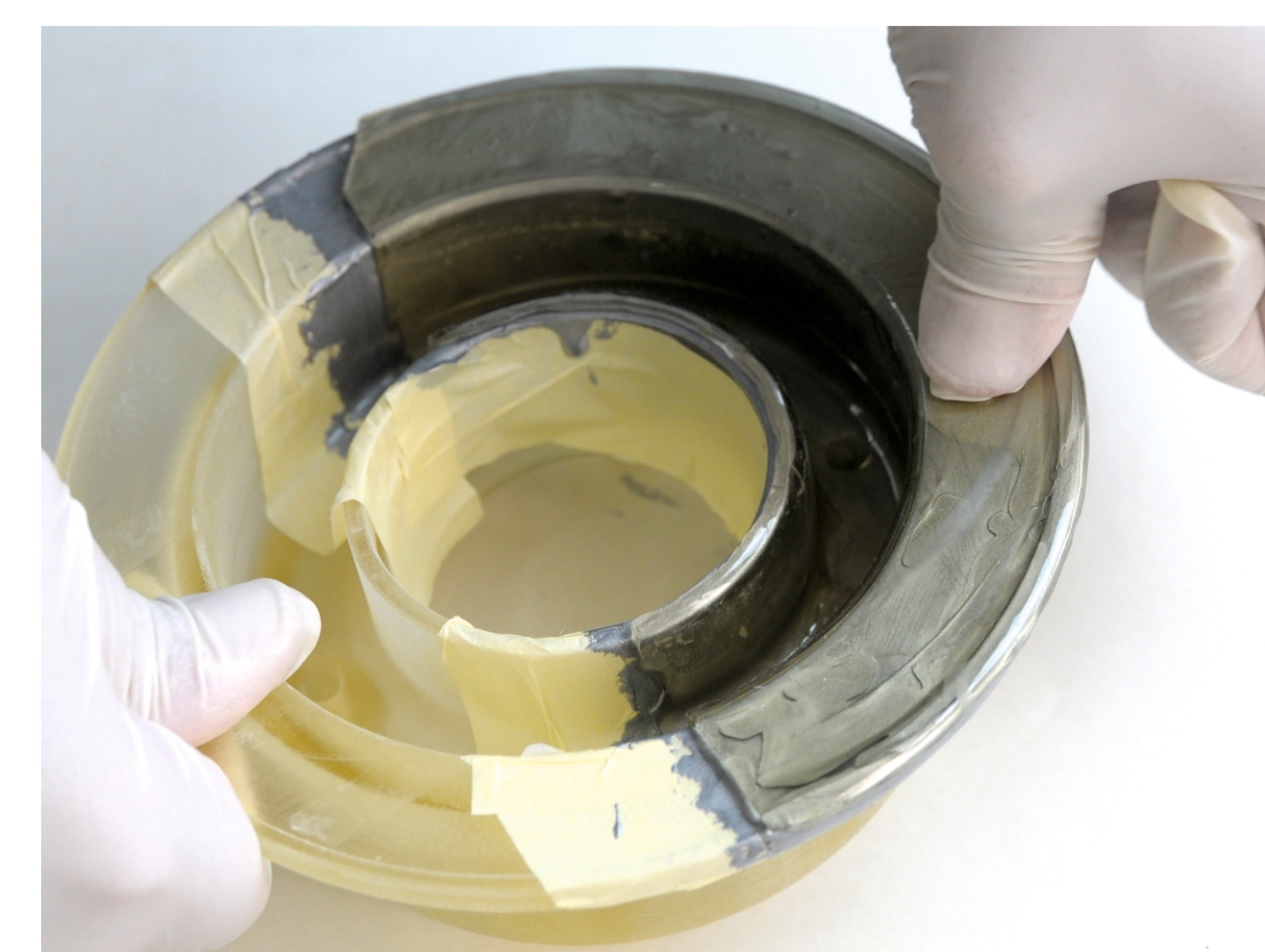
Rys. 10. Przyklejanie powłoki optycznie czynnej klejem aluminiowym PC-1 do piasty koła samolotu Fig. 10. Bonding of cast plastic and the airplane wheel hub model with the use of aluminium glue PC-1
