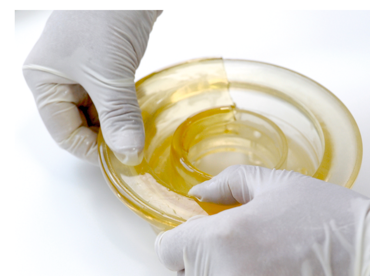
Rys. 5. Formowanie powłoki optycznie czynnej na piastce koła samolotu Fig. 5. Forming of cast plastic on the airplane wheel hub model
