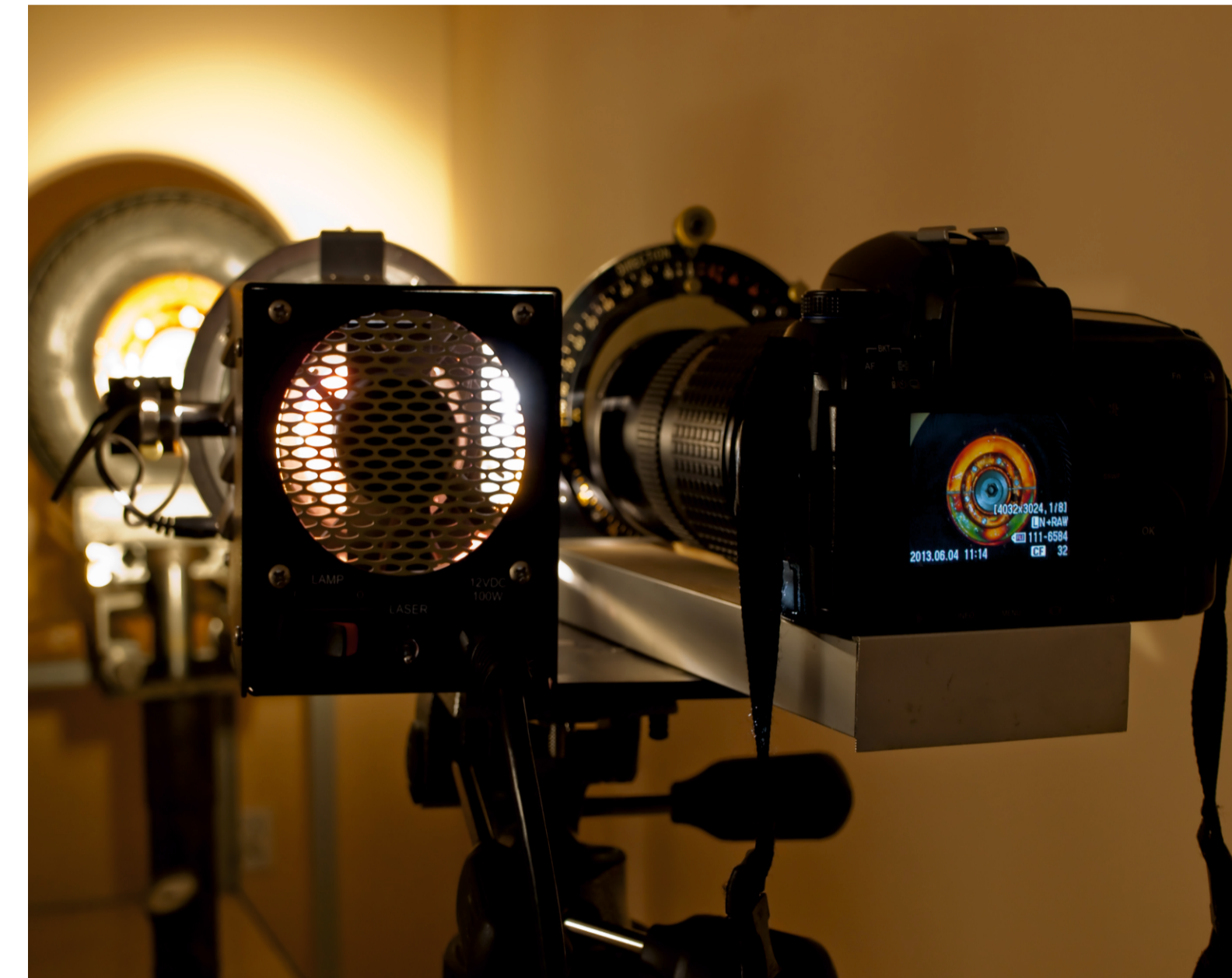
Rys. 11. Stanowisko do analizy rozkładu naprężeń w piastce koła samolotu - metoda światła odbitego Fig. 11. Position to analyze the stress distribution of the in the aircraft wheel hub - the method of reflected light
