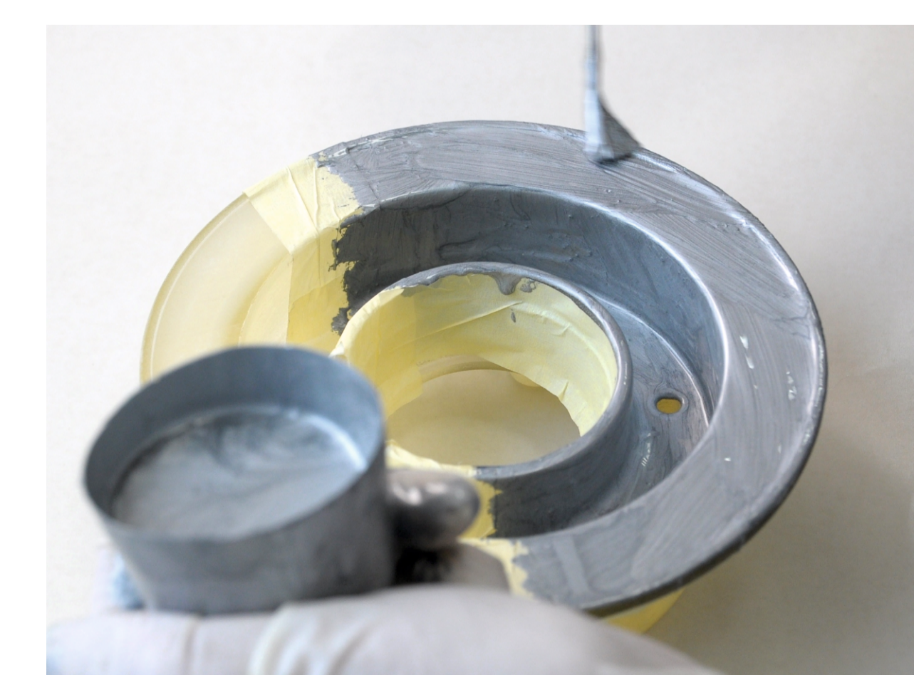
Rys. 9. Przyklejanie powłoki optycznie czynnej klejem aluminiowym PC-1 do piasty koła samolotu Fig. 9. Bonding of cast plastic and the airplane wheel hub model with the use of aluminium glue PC-1
