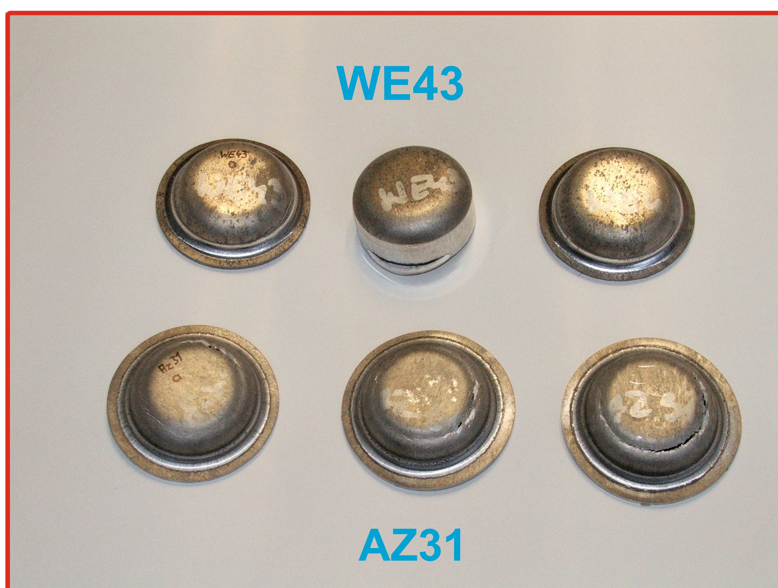
Rys.2. Widok wytloczki z blachy walcowanej ze stopu AZ31 i WE43 po próbie Swifta za pomocą stempla \phi 40 mm Fig.2. View of die stamping from WE43 and AZ31 sheets after Swift test using \phi 40 mm stamp
