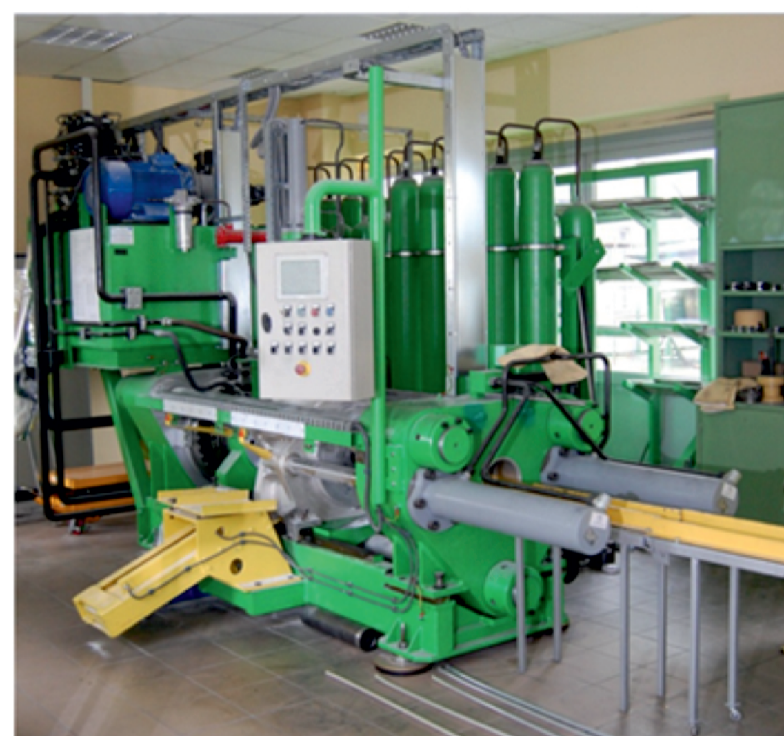
Hydrauliczna prasa pozioma o nominalnej sile nacisku 5 MN do wyciskania przeciwbieżnego typu PH-LR 500 Backward extrusion 5 MN capacity hydraulic press - type PH-LR 500
