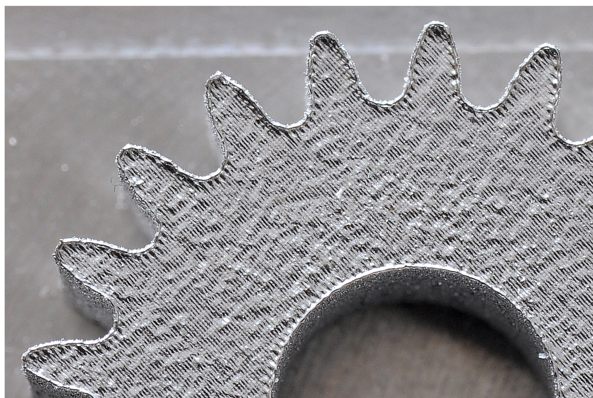
Rys.4. Fragment powierzchni koła zębatego DLMS równoległej do platformy roboczej Fig.4. Fragment of the DLMS gear surfaces parallel to the working platform
