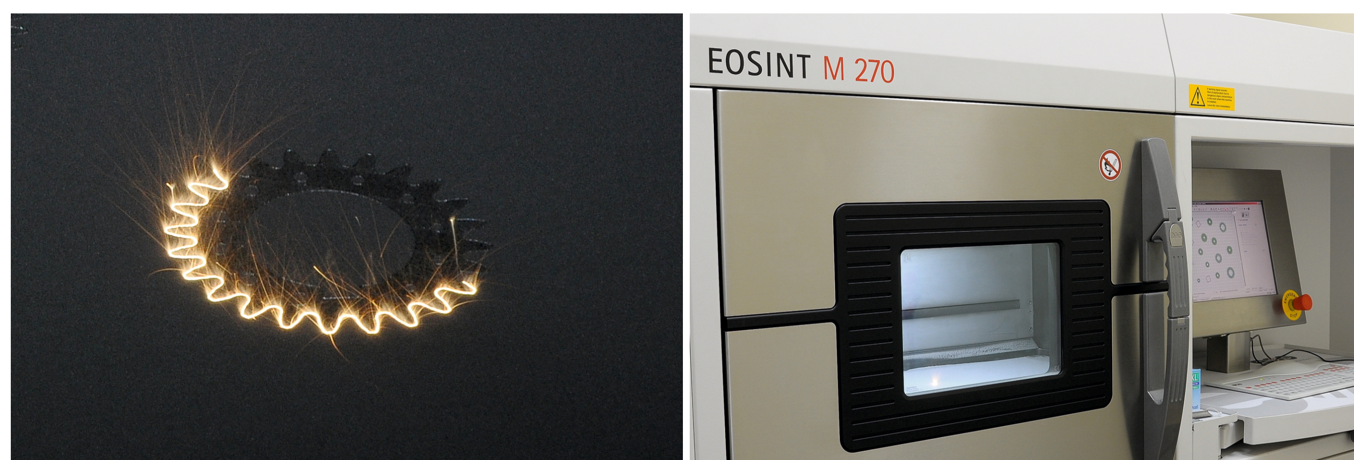
Rys.2. Proces spiekania (DLMS) kół zębatach z proszku ze stopu tytanu Fig.2. The sintering process (DLMS) gears of titanium alloy powder
