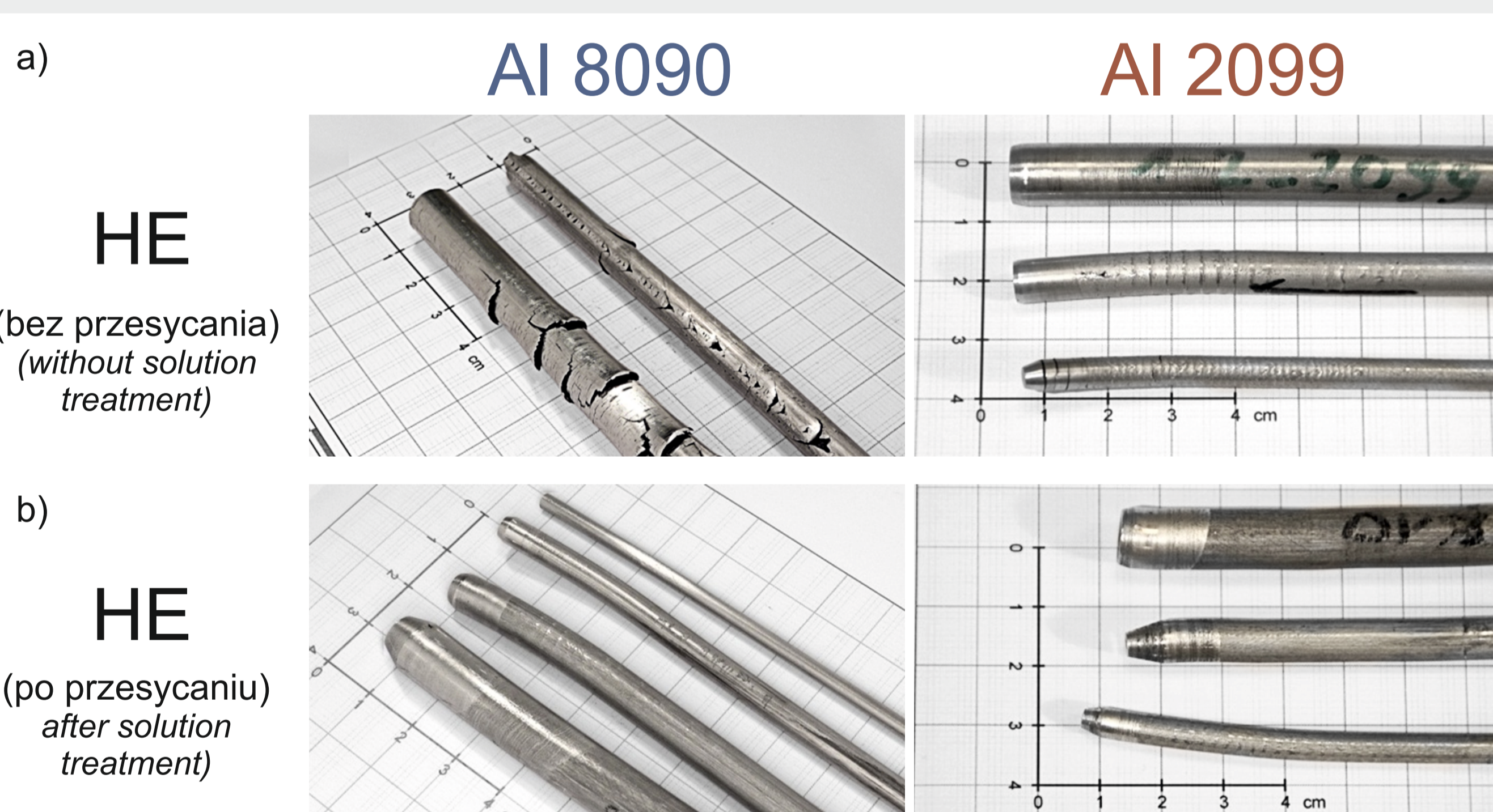
Rys. 6. Zdjęcia wyciskanych prętów. Fig. 6. Photography of the extruded rods.
