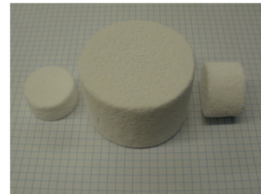
Rys. 3. Porowate kształtki korundowe wytworzone metodą żelowania spienionej zawiesiny przy użyciu agarozu jako środka żelującego
