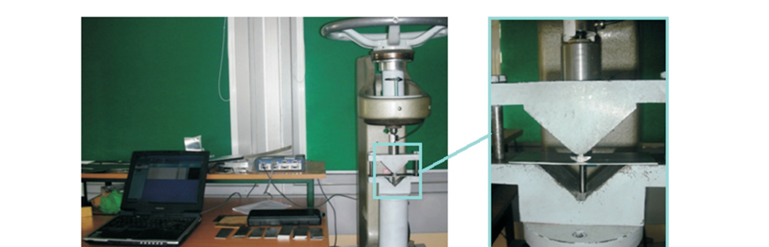
Rys.12. Stanowisko do realizacji procesu gięcia: prasa i oprzyrządowanie Fig.12. Stand for bending test: press, tools and register equipment;
