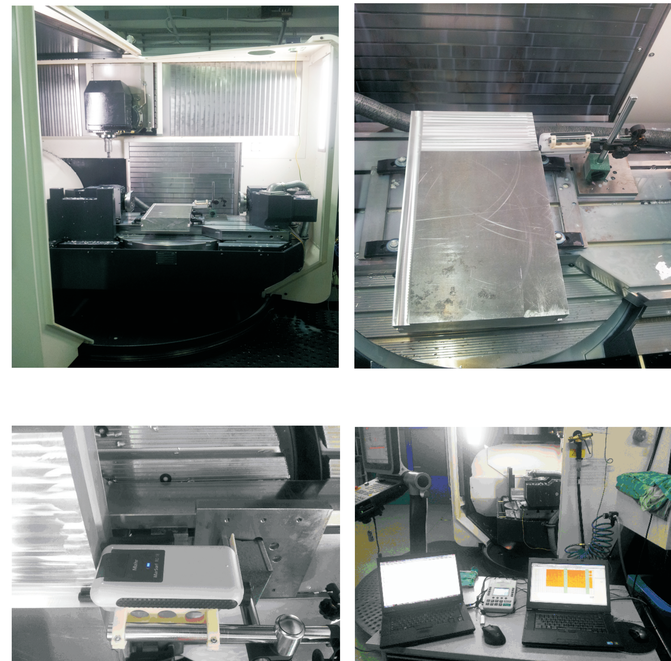
Rys.2. Stawisko do testów. a) maszyna, b) przyrząd mocujący, c) Mahr M300, d) stanowisko pomiarowe Fig.2. The position to test a) machine, b) fastening device, c) Mahr M300, d) measuring position
