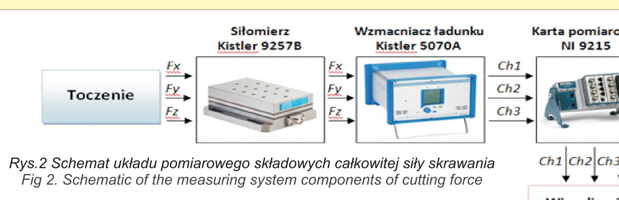
Rys. 2 Schemat układu pomiarowego składowych całkowitej siły skrawania
