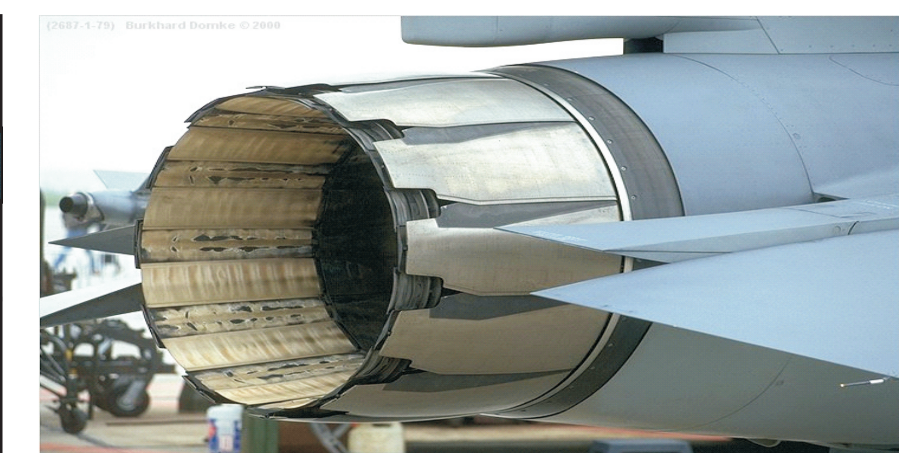
Dysza wylotowa silnika turbodładowanego Exhaust nozzle of a turbojet engine
