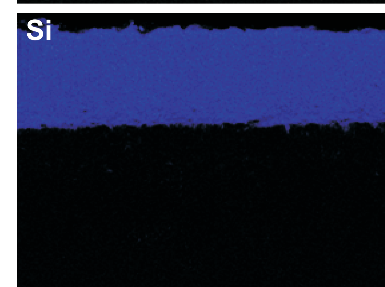
Rozmieszczenie pierwiastków na przekroju poprzecznym powłoki krzemowanej i bariery dyfuzyjnej Elemental distribution on the cross-section of silicide coating and diffusion barrier
