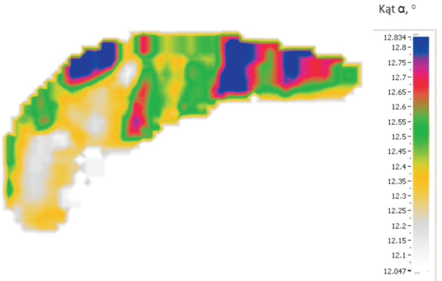
Rys.13. Rozkład wartości kąta \alpha na przekroju poprzecznym pióra rdzeniowanego monokrystalicznego odlewu łopatki Fig. 13. \alpha angle distribution in the cross-section of single crystal blade casting
