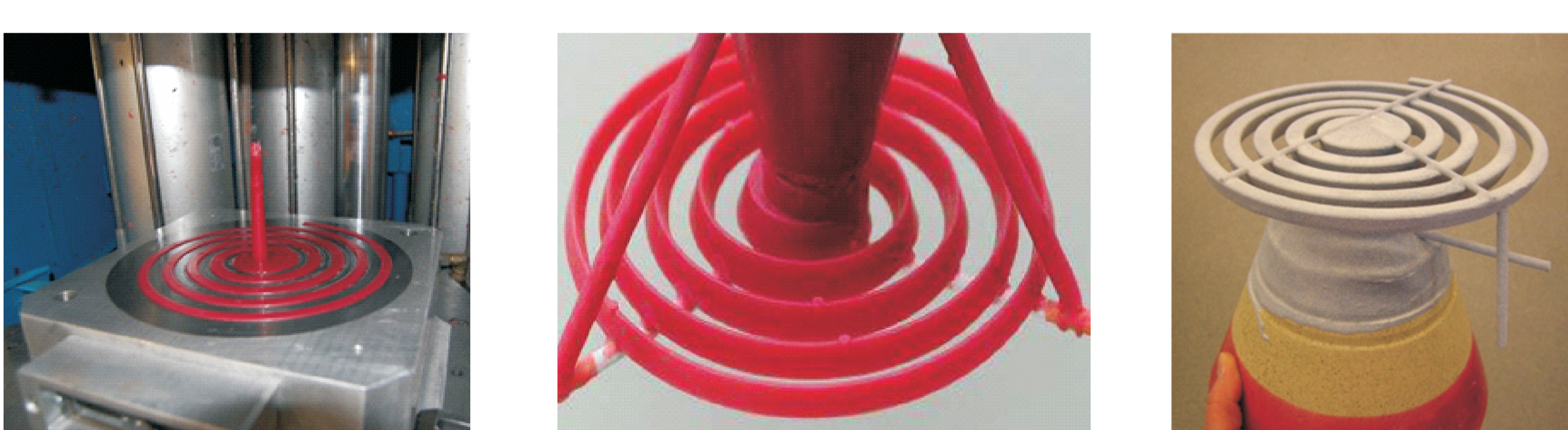
Woskowy zestaw modelowy Wax model assembly Model woskowy spirali Wax model of spiral Forma ceramiczna Ceramic form
