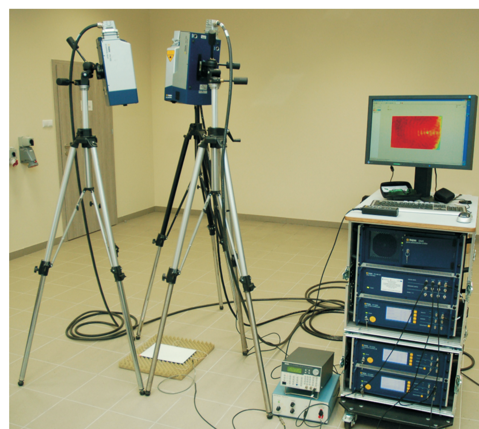
Rys. 4. Laserowy system 3D do bezkontaktowego pomiaru fal sprężystych (Polytec PSV-400-3D) Fig. 4. 3D laser system for the contactless measurement of elastic waves propagation (Polytec PSV-400-3D)
