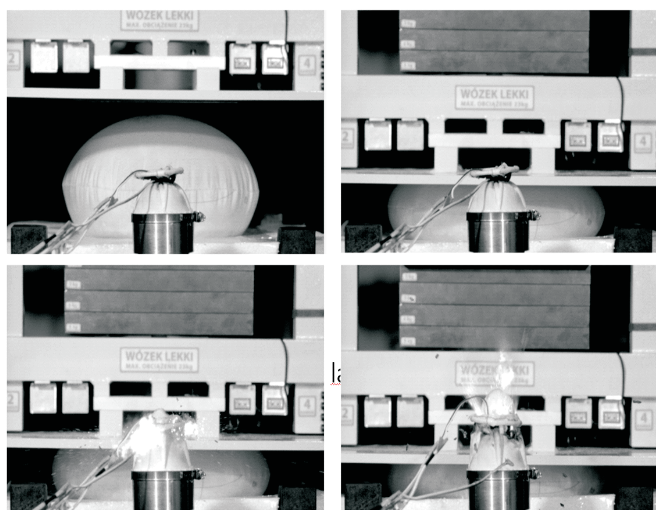
Rys.8. Widok sekwencji pracy zaworu oraz eksperymentalnej poduszki gazowej Fig.8. View of a sequence of valve operation with an experimental airbag system
