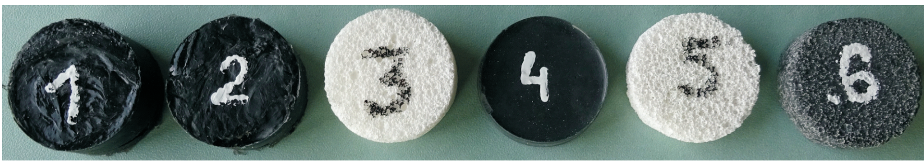
Rys.4. Próbkí materiałowe: (1) kompozyt warstwowy, (2) silikon, (3) pianka ceramiczna Al2O3, (4) elastomer, (5) pianka ceramiczna Al2O3, (6) kompozyt warstwowy Fig.4. Material samples: (1) layered composite, (2) silicon, (3) ceramic foam Al2O3, (4) elastomer, (5) ceramic foam Al2O3, (6) layered composite
