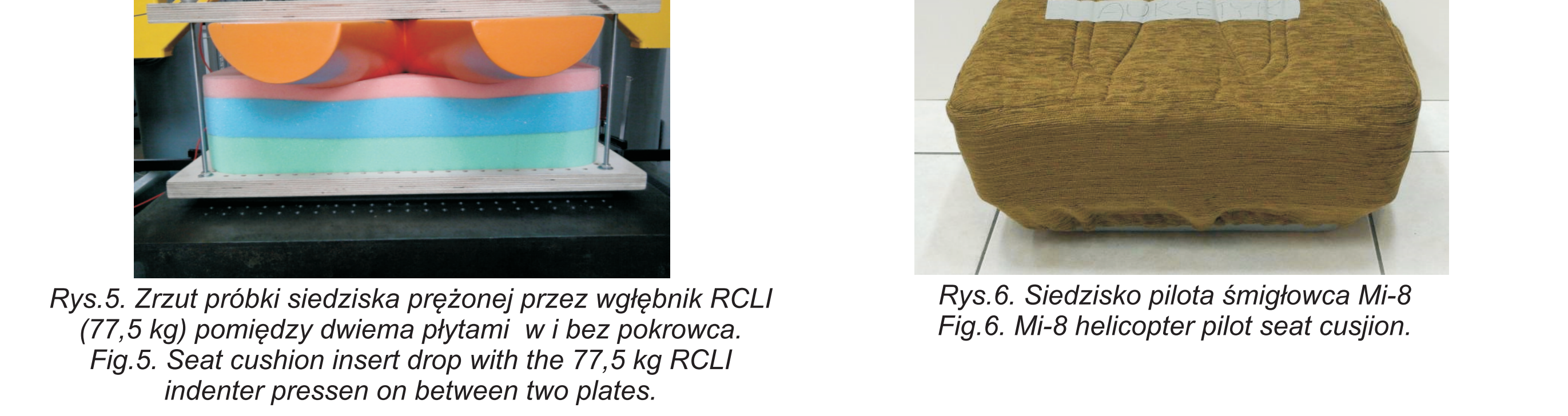
Rys. 5. Zrzut próbki siedziska przez węglanik RCLI (77,5 kg) pomiędzy dwiema płytami w i bez pokrowca. Fig. 5. Seat cushion insert drop with the 77,5 kg RCLI indenter press on between two plates. Rys. 6. Siedzisko pilota śmigłowca Mi-8 Fig. 6. Mi-8 helicopter pilot seat cushion.
