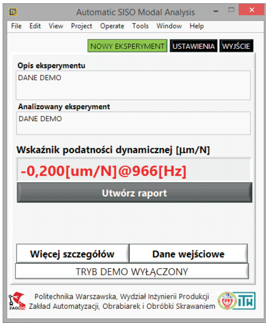
Rys.2. Wyniki analizy modalnej – wskaźnik podatności dynamicznej Fig.2. Results of modal analysis – dynamic compliance indicator
