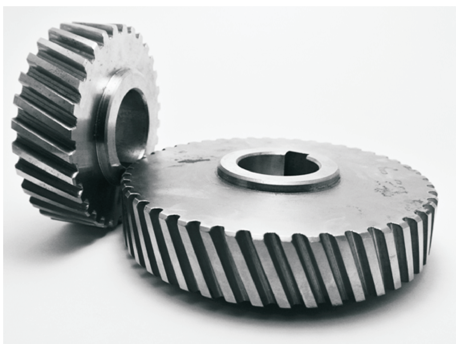
Rys. 1. Widok badanych kół zębatych Nowikowa Figure 1 Novikov gears for endurance testing
