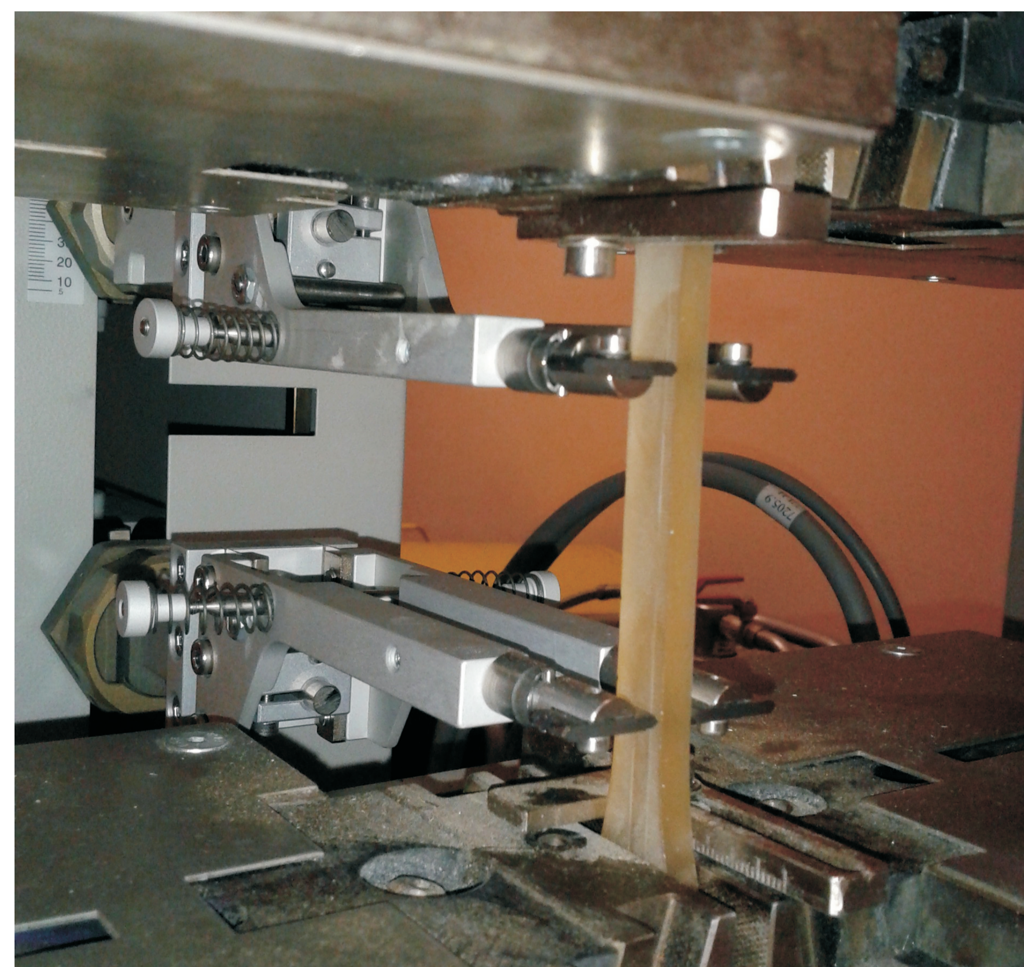
Rys. 12. Wyznaczanie modułu Younga Fig. 12. Determination of the Young's modulus
