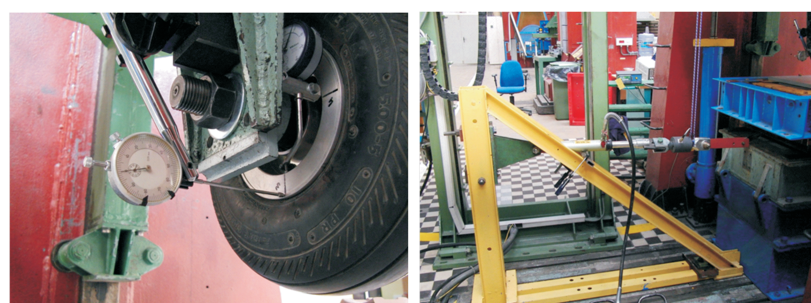
Fot. 1. Sposób pomiaru odkształcenia piasty podczas prób obciążenia promieniowego. Fig. 1. Measurement principle of hub deflection for radial loads test
