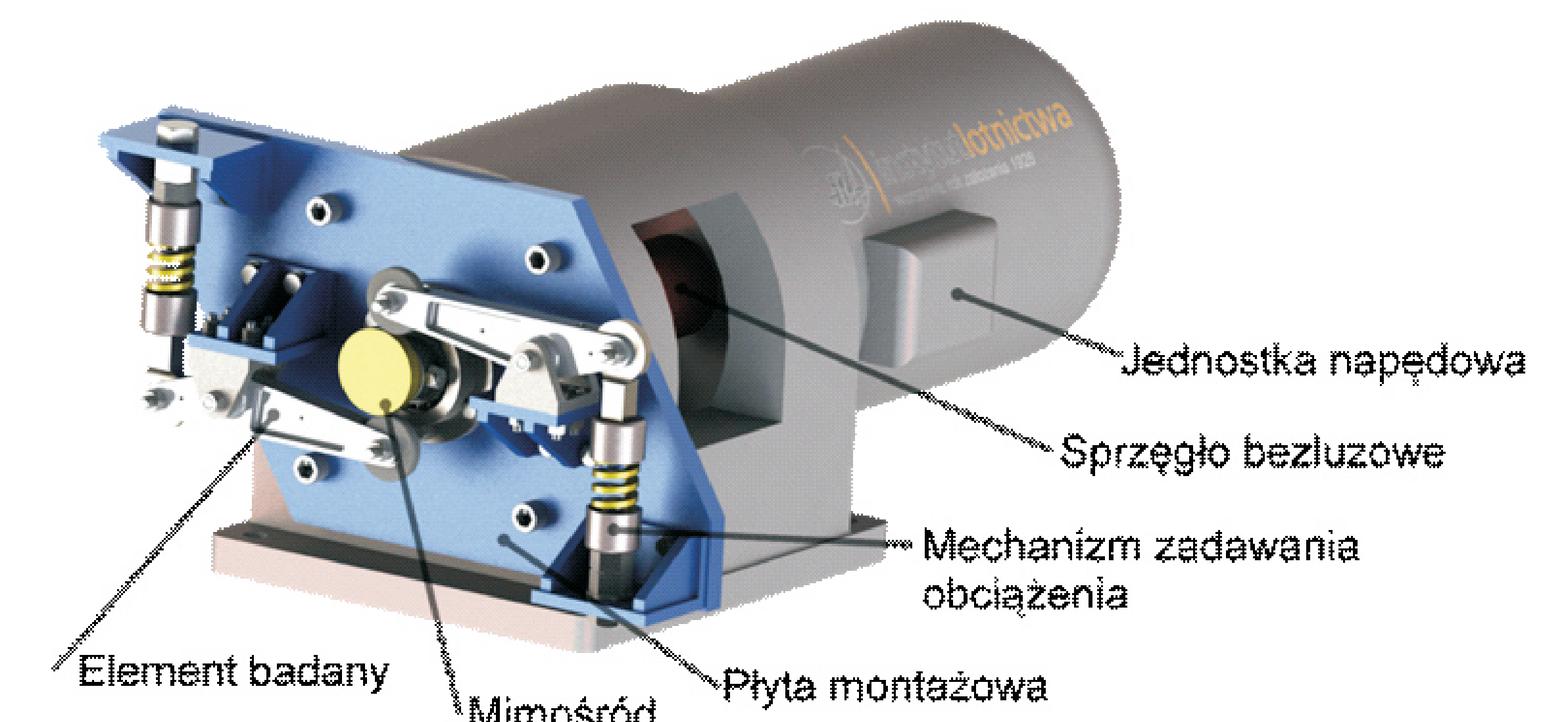
Rys. 6. Wizualizacja stanowiska do badań zmęczeniowych dźwigni. Fig. 6. Lever fatigue test stand visualisation
