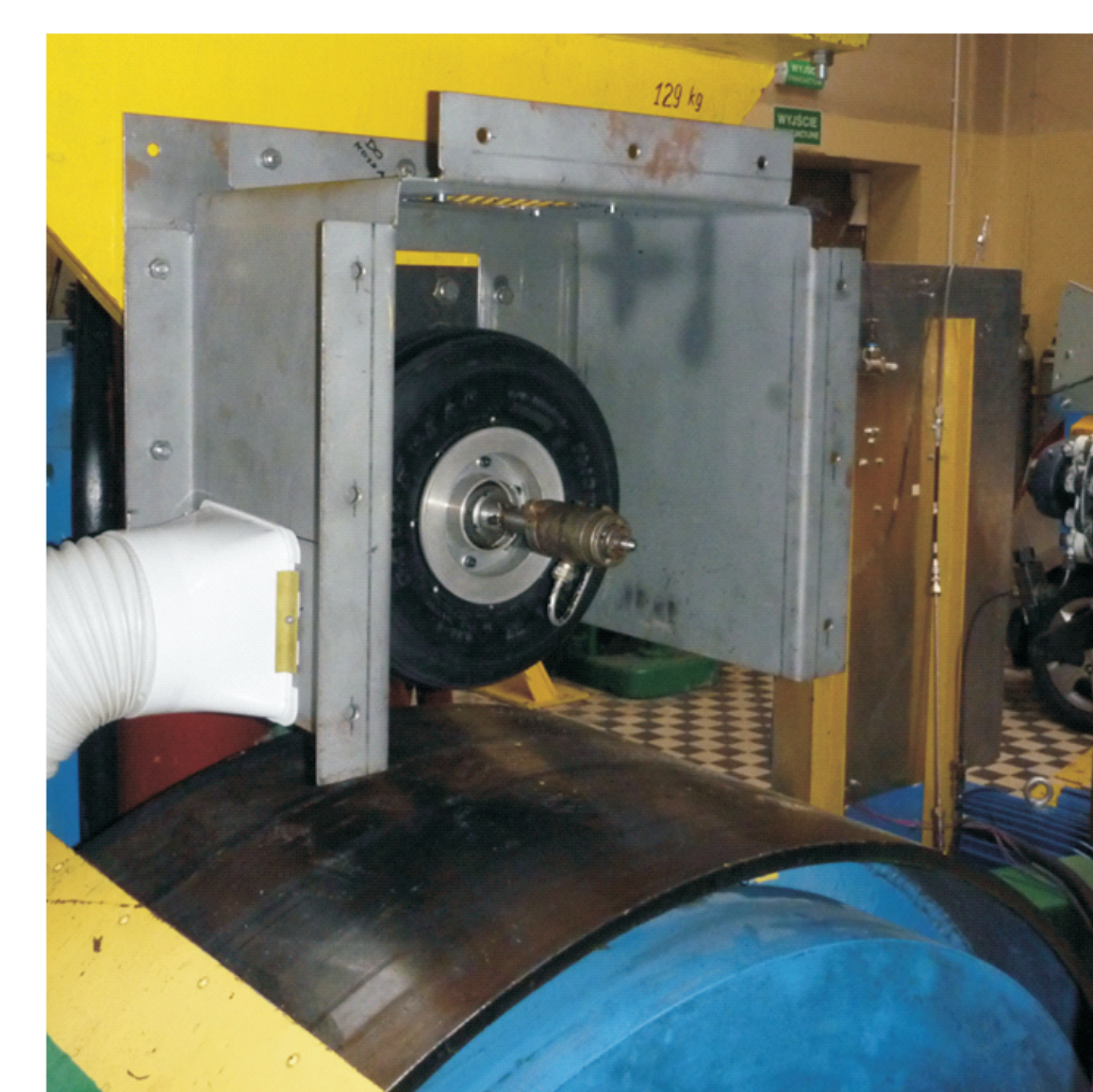
Fot. 4. Konfiguracja stanowiska do próby toczenia. Fig. 4. Mlot 3T test stand configuration for wheel rolling test
