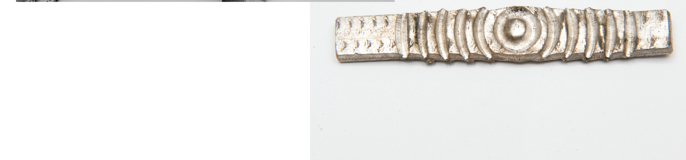
Rys. 6. Przykład tłoczności produktu konsolidacji stopu Az61 Fig. 6. Example of press-formability AZ61 alloy product after consolidation
