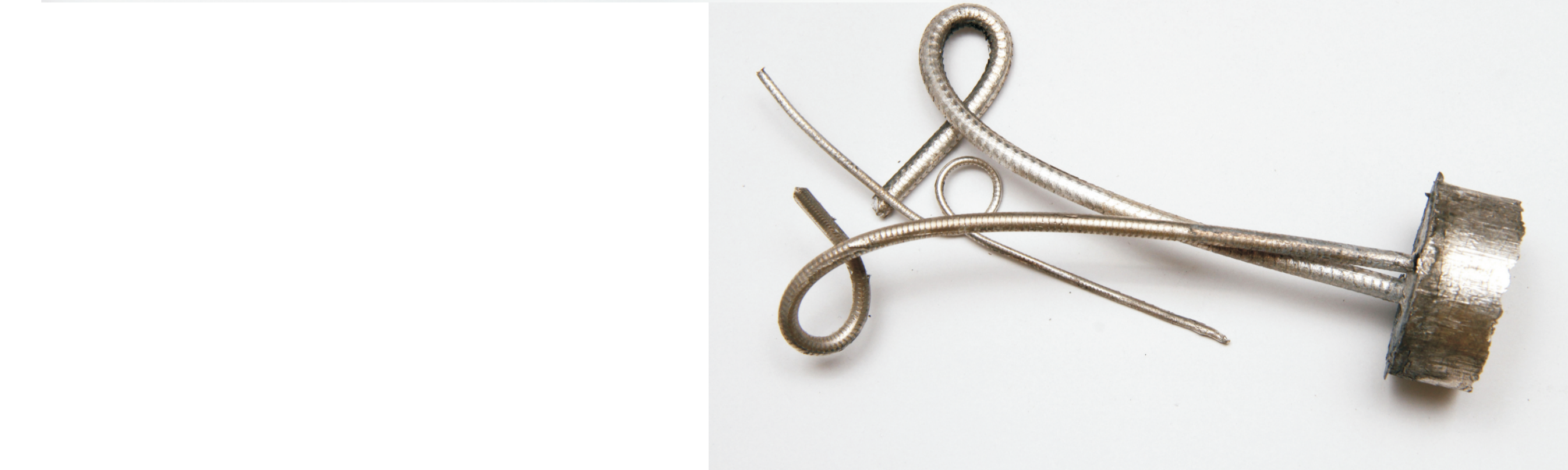
Rys. 5. Przykład plastyczności produktu konsolidacji stopu Az61 Fig. 5. Example of ductility AZ61 alloy product after consolidation
