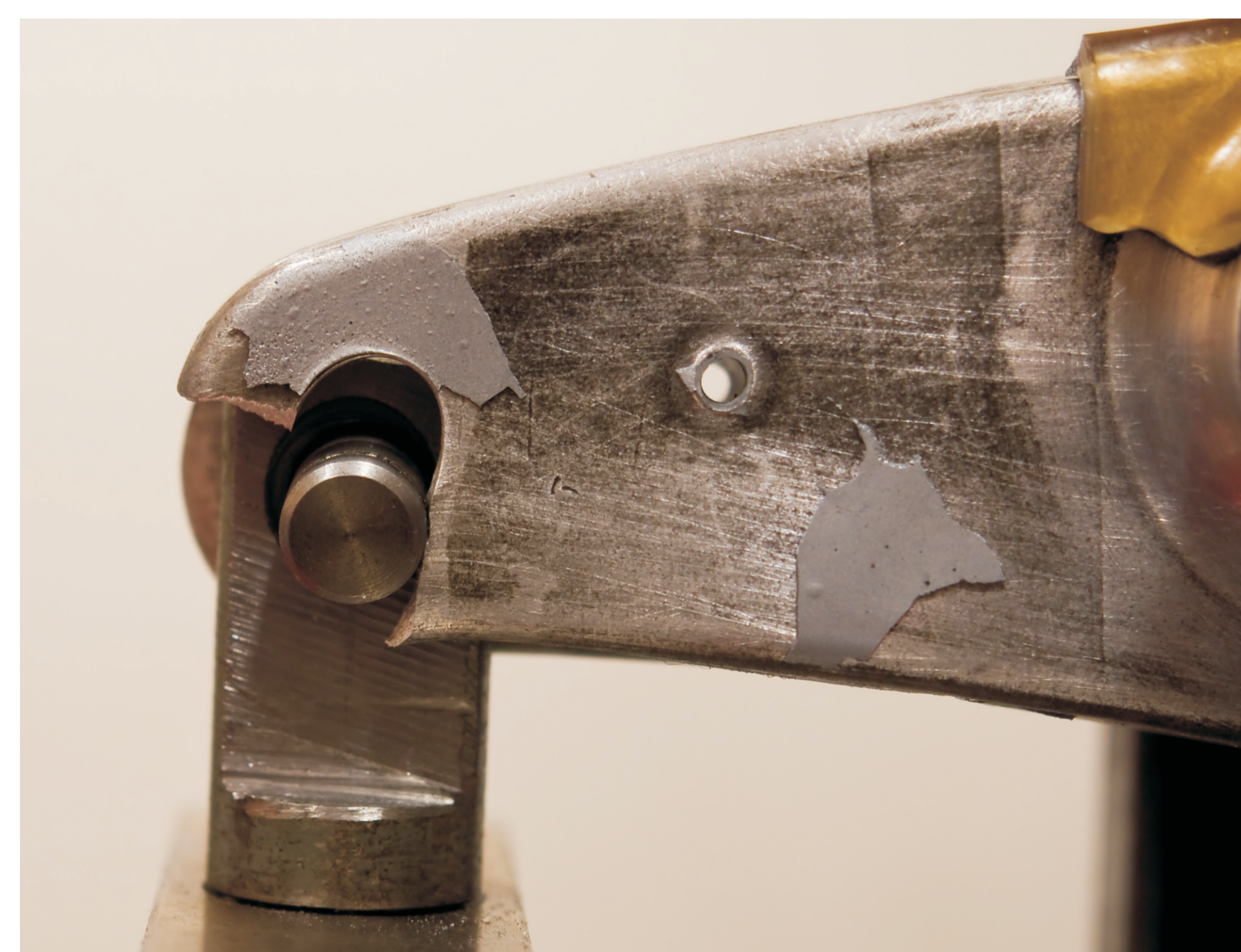
Rys. 6. Uszkodzenie w obszarze sworznia na krótkim ramieniu dźwigni układu sterowania śmigłowca Fig.6. Damaged central pin of the short lever of the helicopter control system
