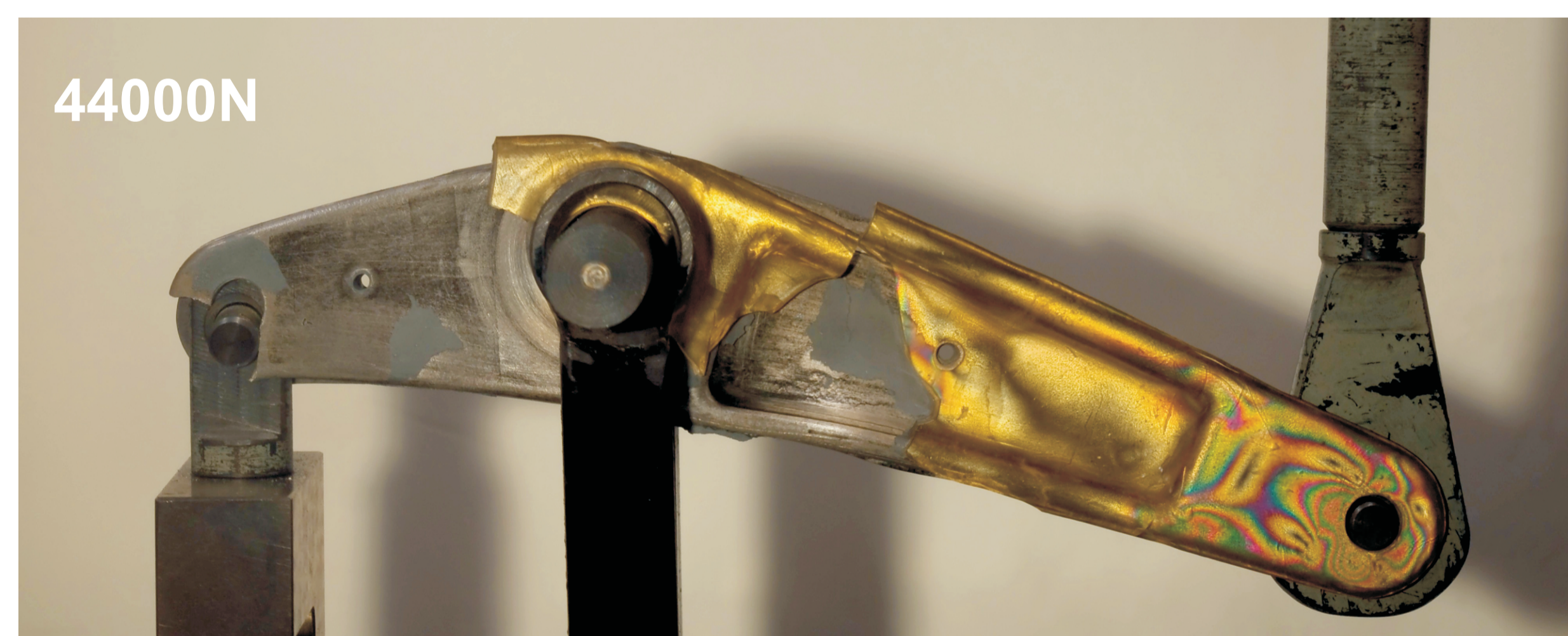
Rys. 5. Rozkład naprężeń w dźwigni układu sterowania śmigłowca - obciążenie siłą w zakresie 12000N do 44000N na krótkim ramieniu Fig.5. The stress distribution in the helicopter control system lever - load force in the range of 12000N to 44000N on the short arm
