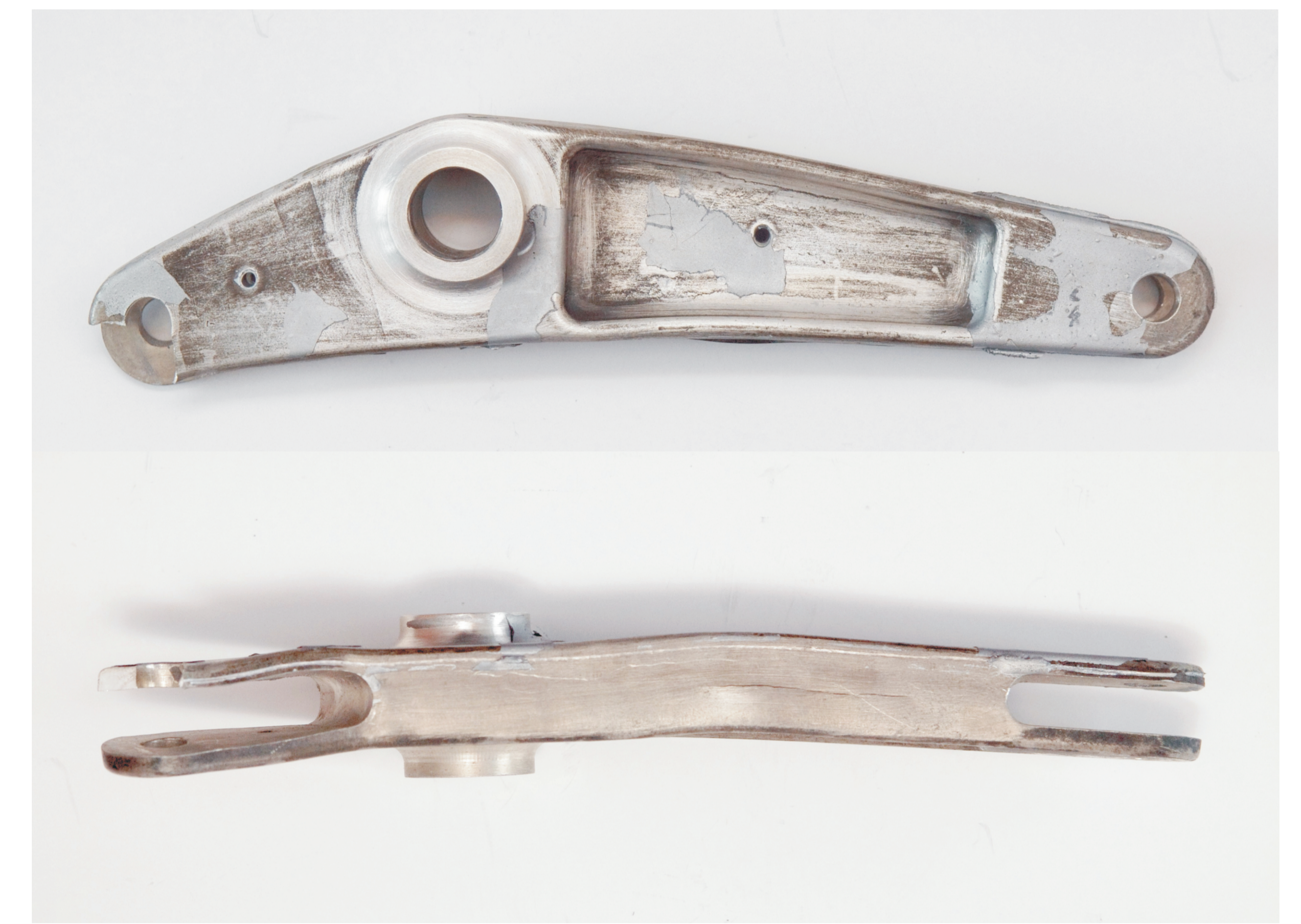
Rys. 7. Deformacja dźwigni układu sterowania śmigłowca w wyniku przyłożonego obciążenia 44kN Fig.7. 44kN load deformation of the lever of the helicopter control system
