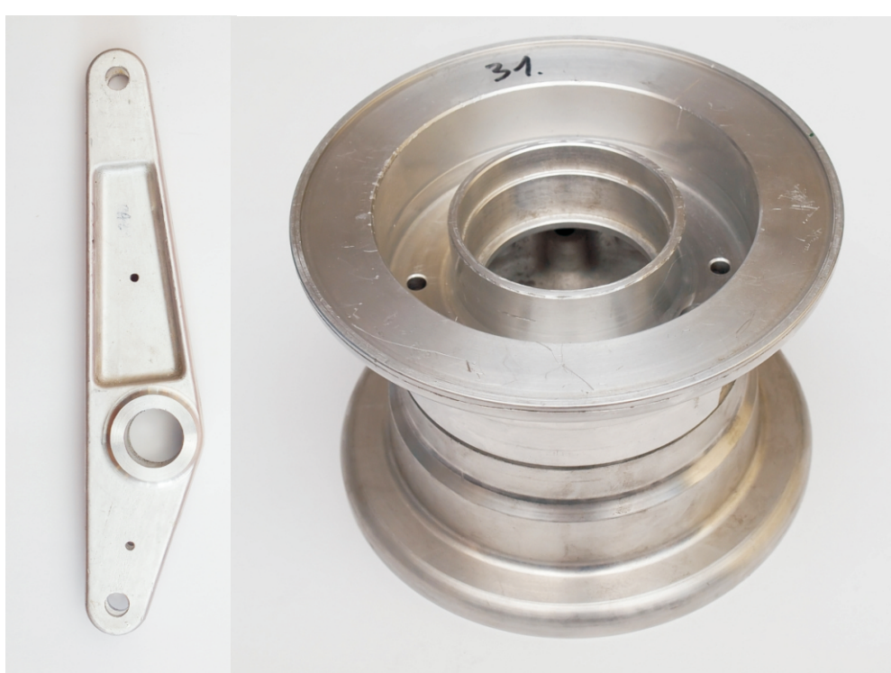
Rys.2. Odkuwki ze stopu PA31 części lotniczych Fig.2. Forged PA31 alloy aircraft parts
