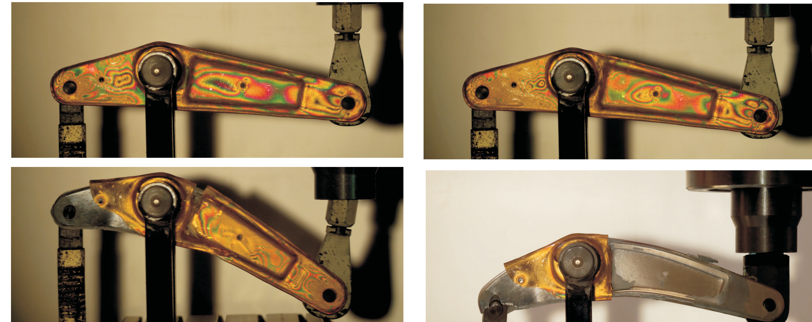
Rys.5. Rozkład naprężeń w dźwigni układu sterowania śmigłowca - obciążenie siłą w zakresie 24000N do 64000N Fig.5. The stress distribution in the helicopter control system lever - load force in the range of 24000N to 64000N
