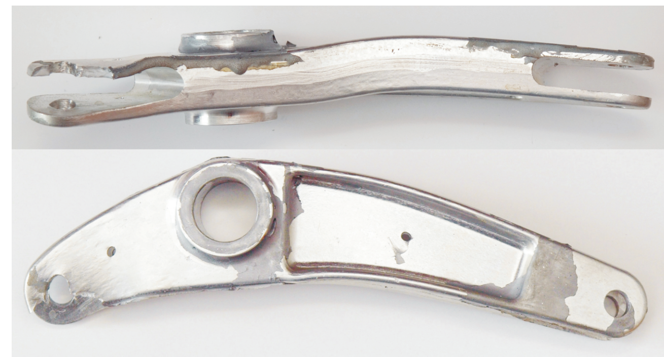
Rys.6. Deformacja dźwigni układu sterowania śmigłowca w wyniku przyłożonego obciążenia 64kN Fig.6. 64kN load deformation of the lever of the helicopter control system
