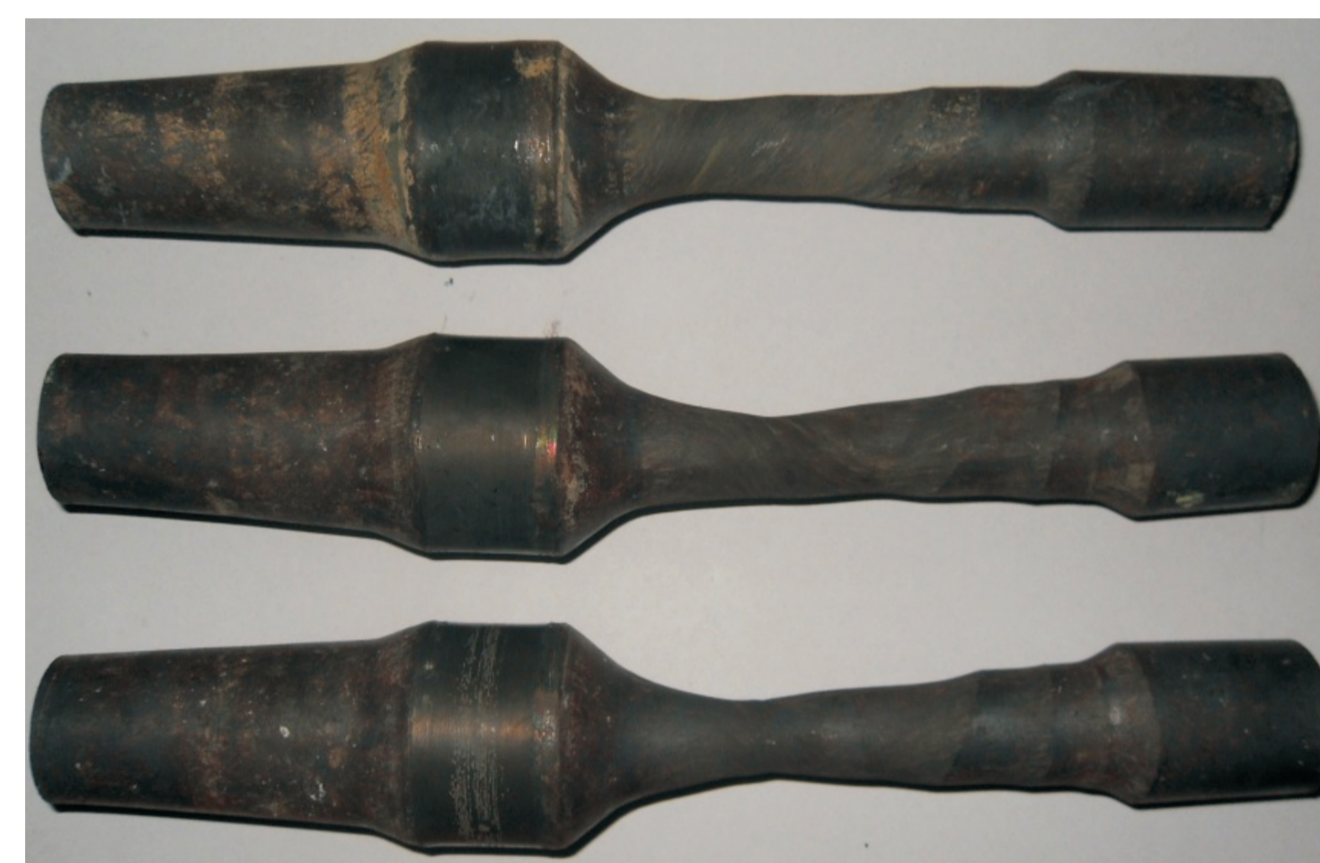
Rys. 6. Przedłuki dźwigni ze stopu tytanu odwalcowane w procesie walcowania poprzeczno-klinowego Fig. 6. Titanium alloy preforms for lever forging obtained in cross-wedge rolling process
