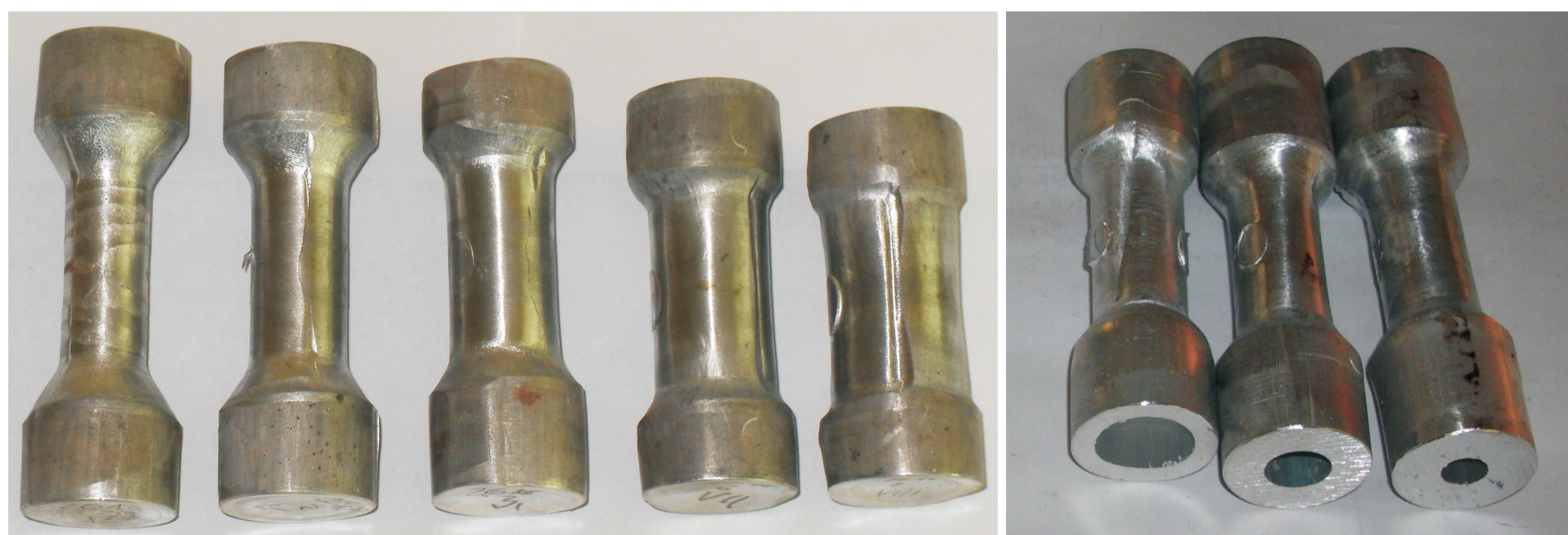
Rys. 1. Odłuki pełne ze stopu 2618A wykonane metodą walcowania poprzeczno-klinowego Fig.1. Solid forgings made of 2618A alloy by cross-wedge rolling method
