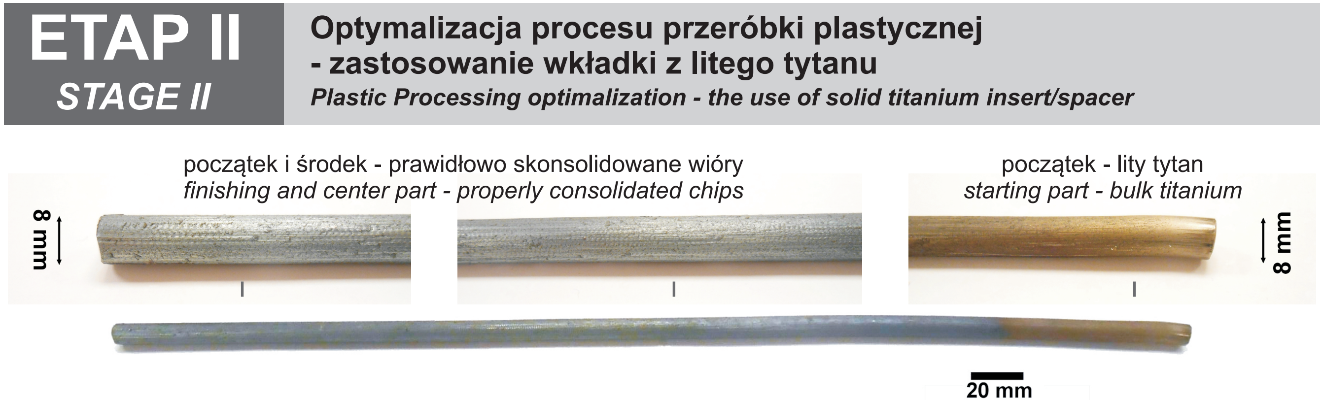
Rys. 6. Produkt wyciskania wiórów tytanowych (metodą KoBo) z zastosowaniem przekładki z litego tytanu
