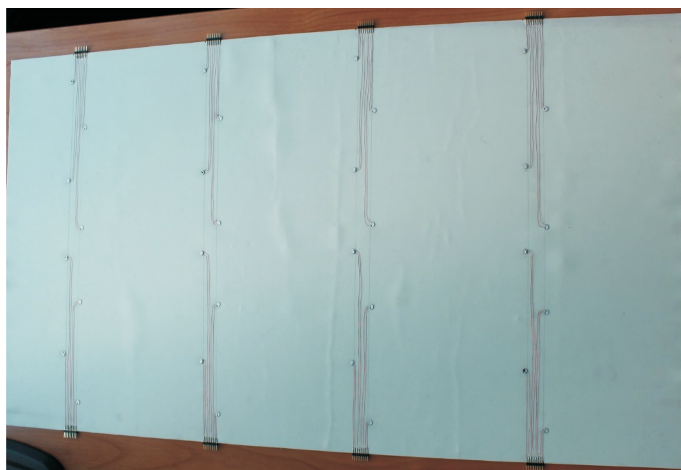
Rys.1. Sposób rozmieszczenia przetworników PZT w strukturze Fig.1. Distribution of the PZT transducers in structure
