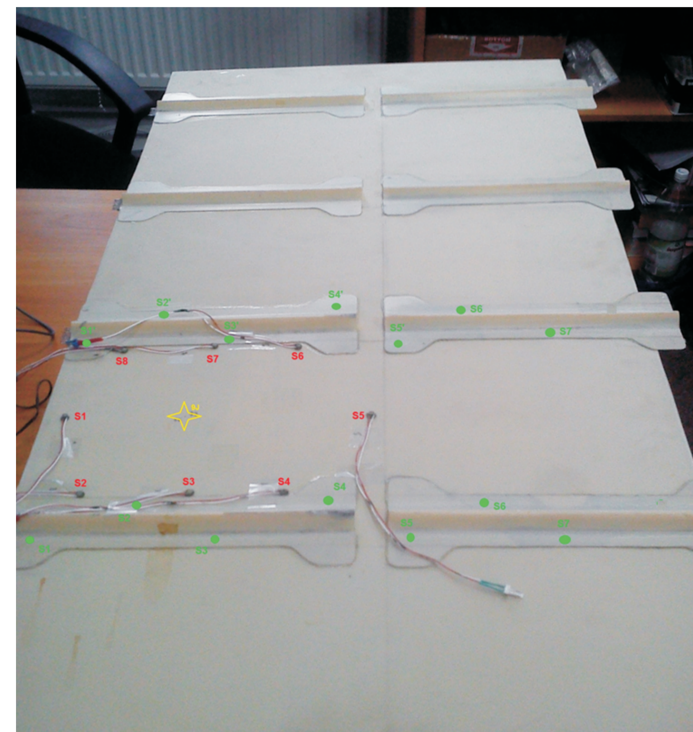
Rys.3. Widok demonstratora technologii z zaznaczeniem lokalizacji uderzeń oraz przetworników obu sieci (kolor zielony – przetworniki wbudowane w strukturę kompozytu, kolor czerwony – przetworniki umocowane na powierzchni demonstratora) Fig.3. Demonstrator with impact localization and PZT (green - embedded in structure, red - mounted on the surface)
