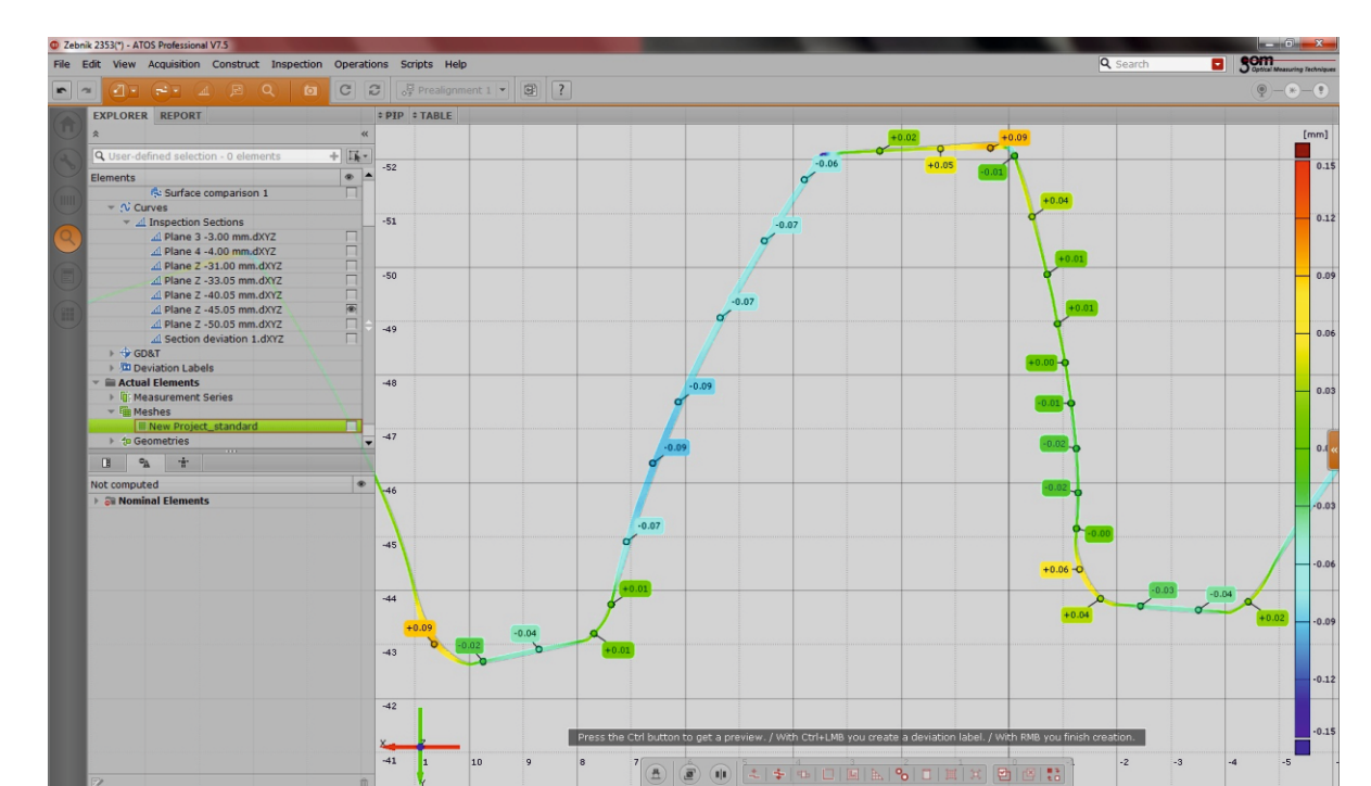
Rys. 15. Analiza odchyłek zarysu zębniaka. Fig. 15. Analysis of the displacement of pinion tooth profile
