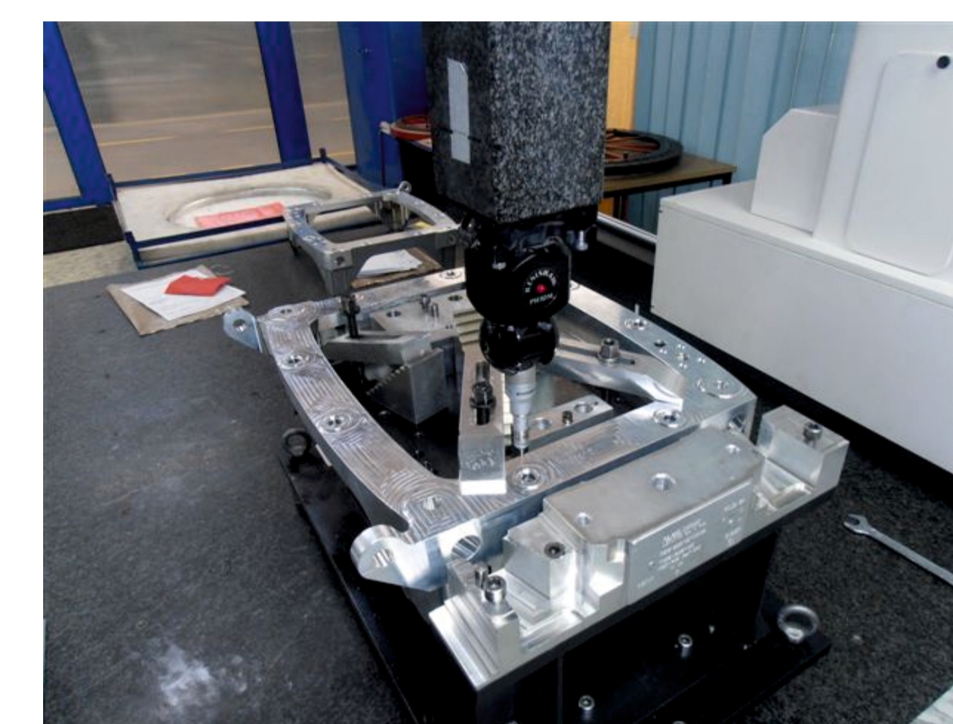
Pomiar na CMM pod obciążeniem CMM measurements with loading
