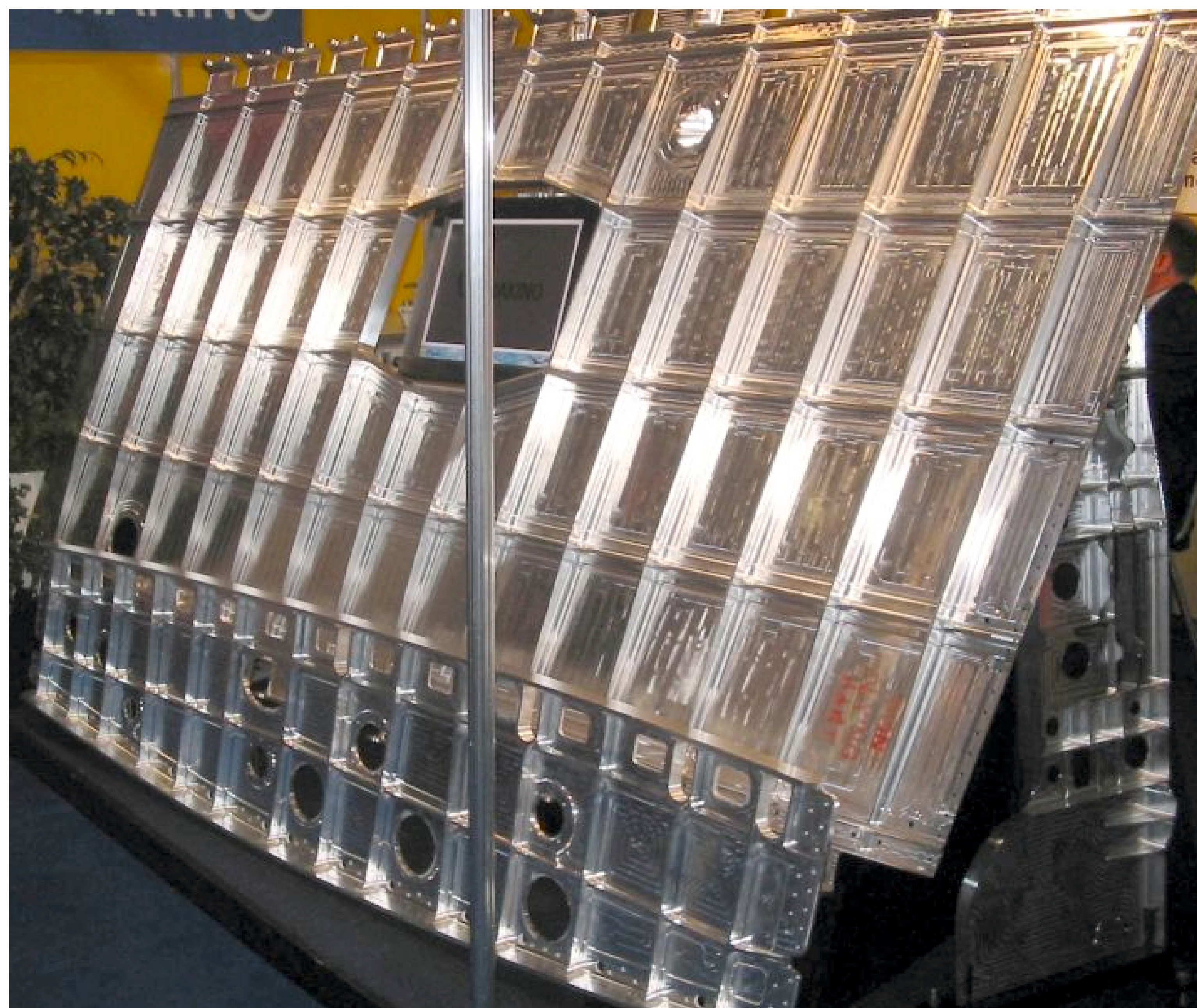
Przykłady detali integralnych wykonywanych na maszynie CNC Examples of integral parts manufactured with CNC machine
