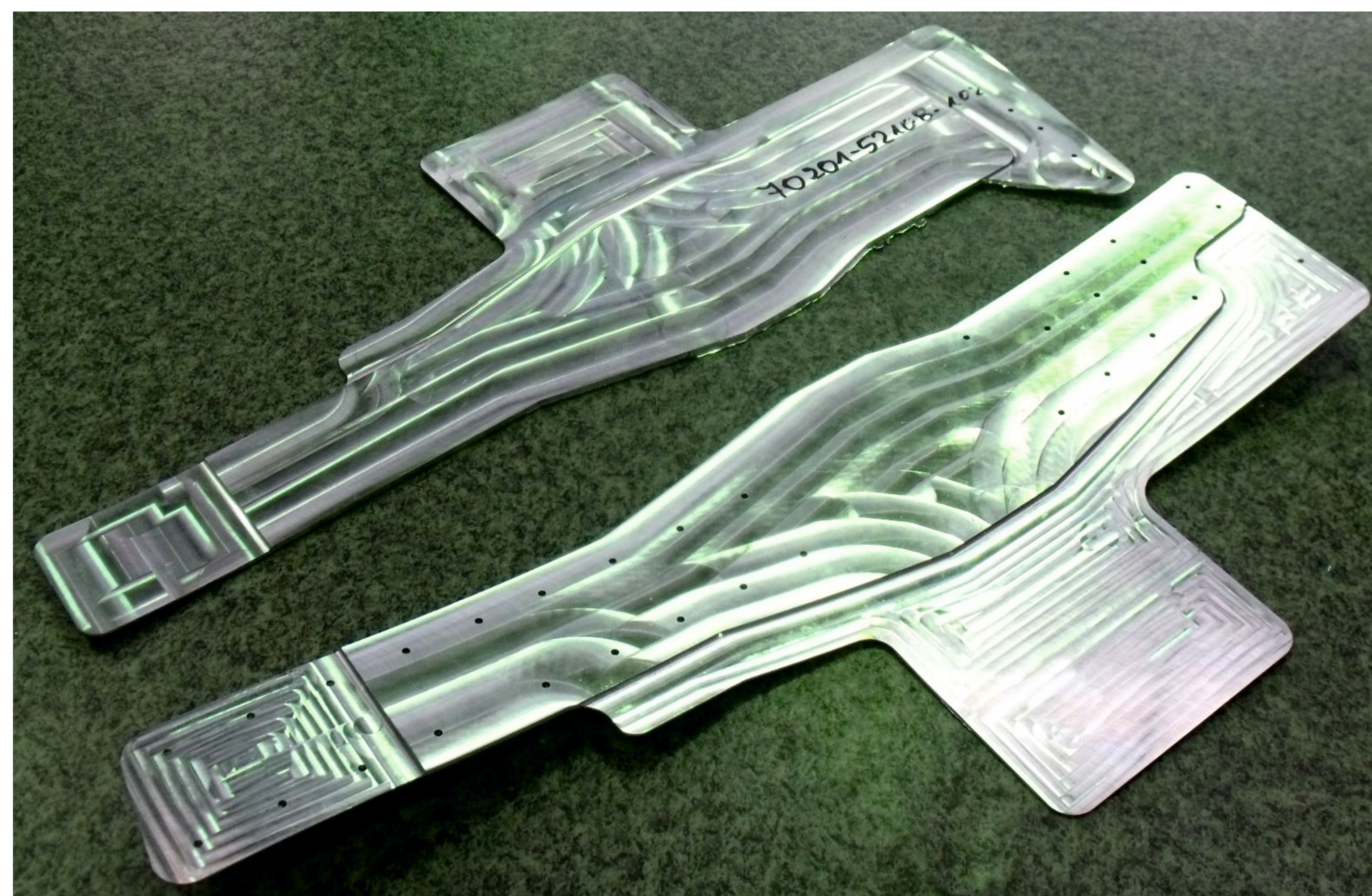
Przykład odkształconego detalu płaskiego po obróbce skrawaniem Example of deformed flat detail after machining
