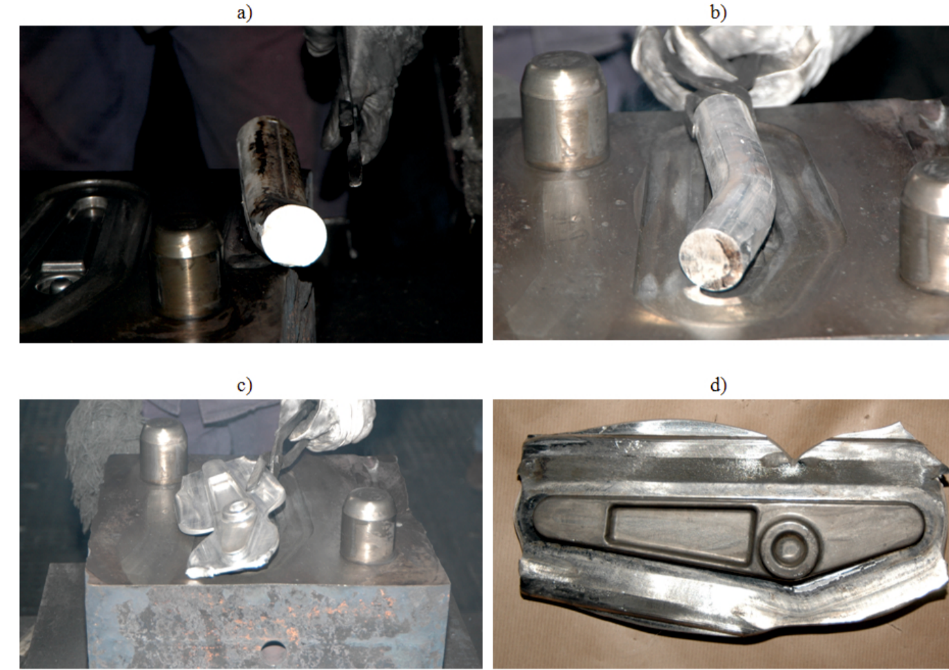
Rys. 1. Kształt wyrobu po następujących etapach kucia: a) gięcie, b) przed kuciem wstępnym, c) po kuciu wstępnym, d) gotowa odkuwka z wypływka Fig. 1. The product shape after the following forging stages: a) bending, b) before preliminary operation, c) after preliminary operations, d) final drop forging with flash.
