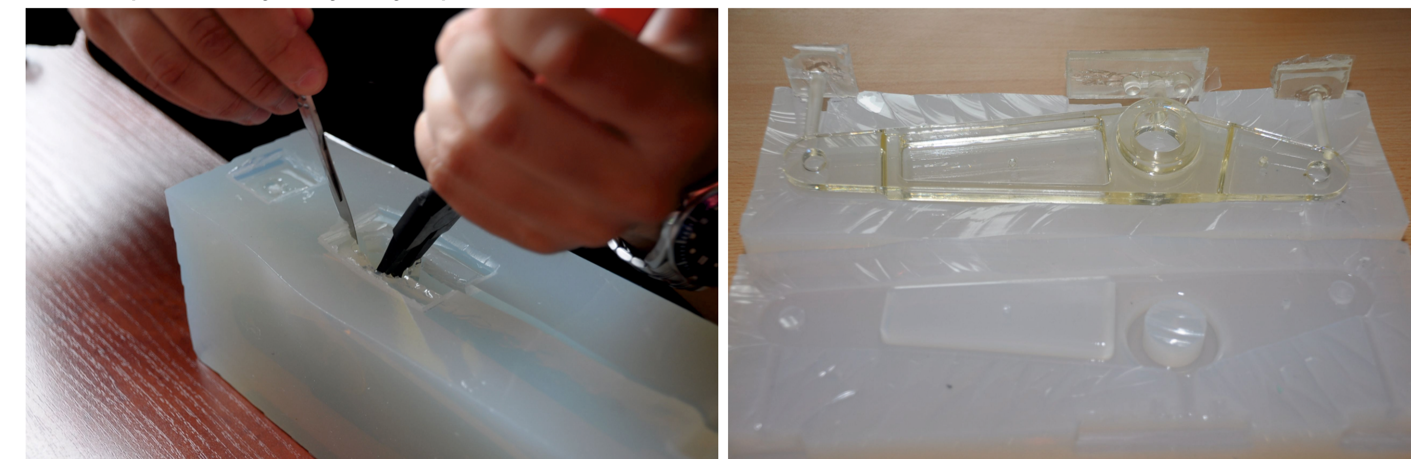
Rys. 3. Przygotowanie modelu VC dźwigni z żywicy Epidian 53 Fig. 3. Preparation of the VC model of the lever of Epidian 53 resin
