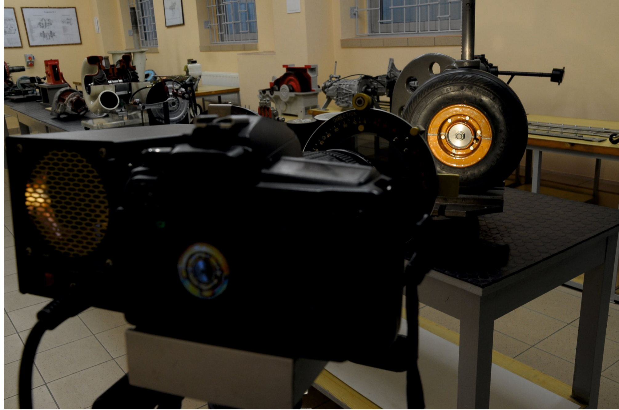
Rys. 1. Stanowisko do analizy rozkładu naprężeń od siły pionowej w piaście koła samolotu - metoda światła odbitego Fig. 1. Position to analyze the stress distribution of the vertical strength in the aircraft wheel hub - the method of reflected light
