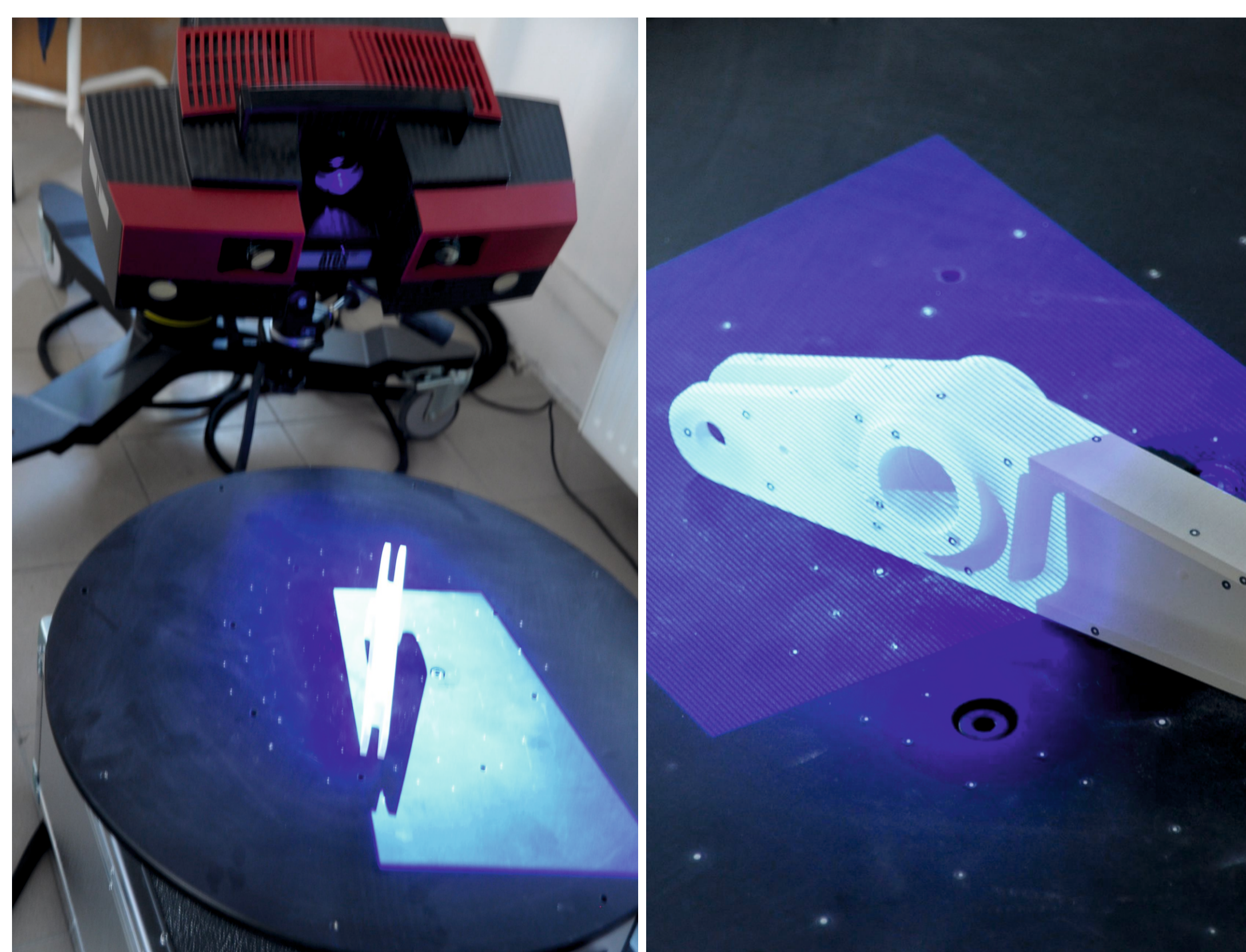
Rys. 6. Skaner ATOS II - wykorzystanie światła niebieskiego do pomiaru dźwigni Fig. 6. ATOS II scanner - use blue light to measure the lever
