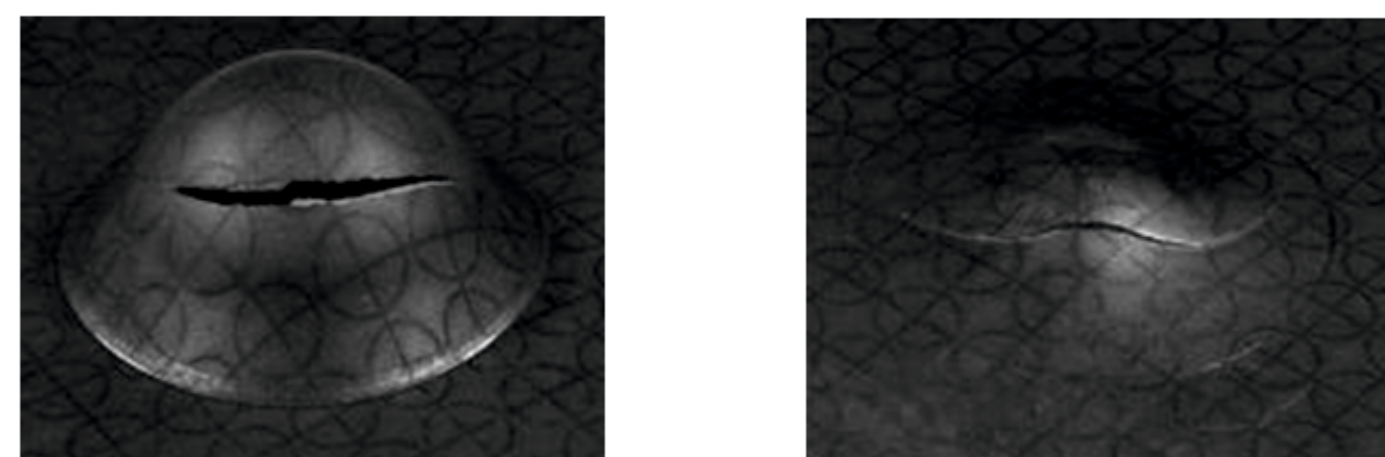
Rys. 1. Widok próbek po próbie tłożności wg metody Erichsena a) Grade 2, b) Ti6Al4V Fig. 1. View of the cups after Erichsen cupping test a) Grade 2, b) Ti6Al4V
