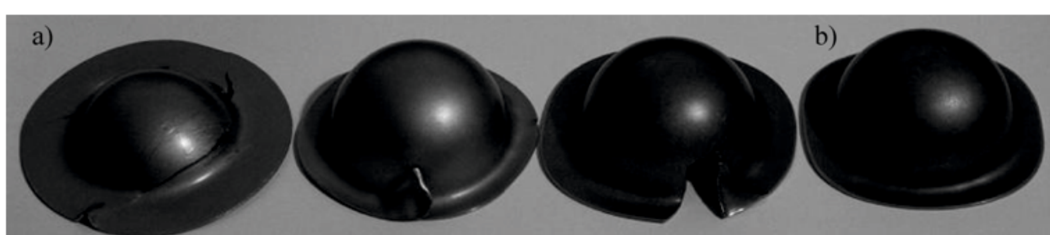
Rys. 2. Wyniki prób kształtowania czaszy kulistej z blachy ze stopu tytanu Ti6Al4V a) przy niewłaściwie dobranych parametrach procesu i średnicy wytloczki, b) właściwie ukształtowana wytloczka Fig. 2. Test results of forming the spherical cup from Ti6Al4V titanium alloy a) with improper b) with correct forming parameters
