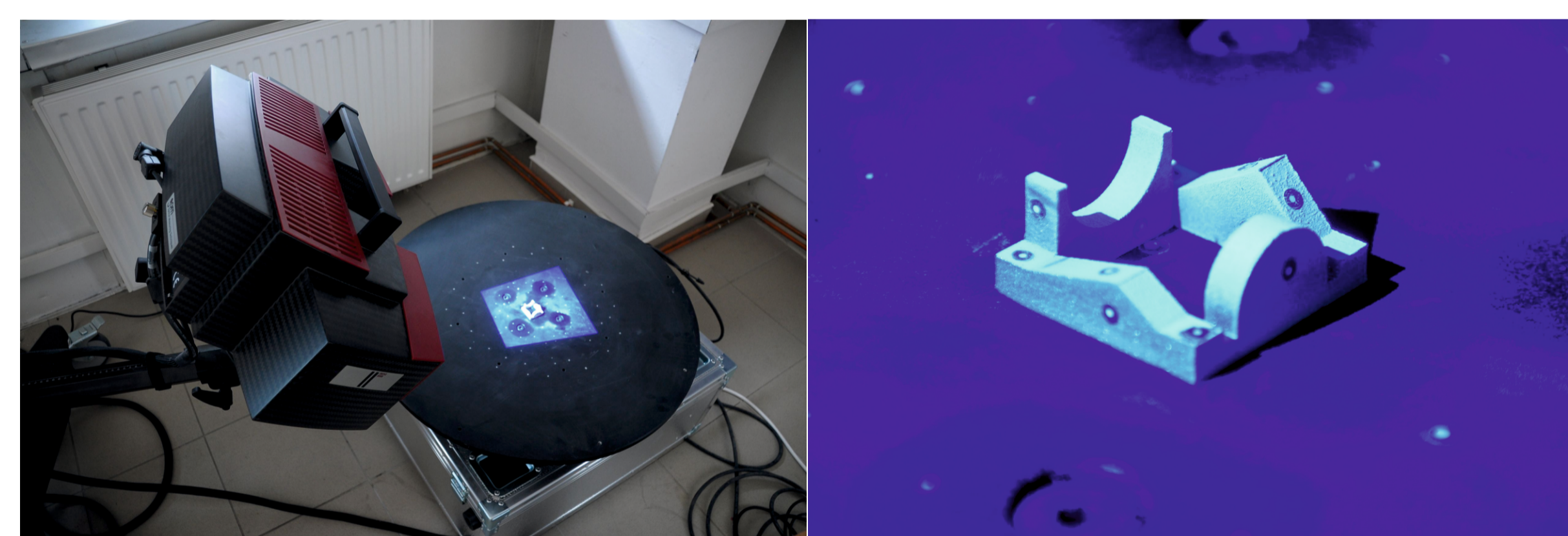
Rys. 9. Pomiar modeli EOS-SLS z wykorzystaniem skanera ATOS II na światło niebieskie Fig. 9. Measurement of the EOS-SLS models with ATOS II scanner by blue light
