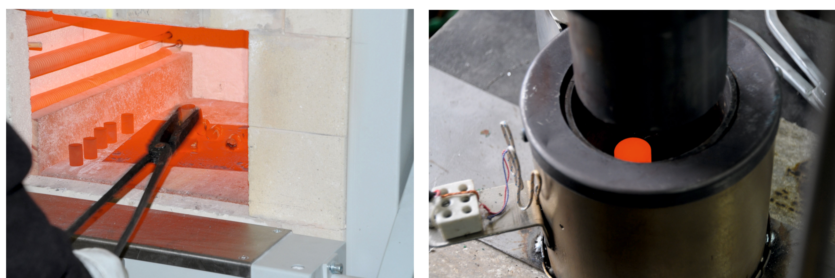
Rys. 2. Spękanie próbek ze stopu Ti6Al4V Fig. 2. Upsetting Ti6Al4V alloy samples
