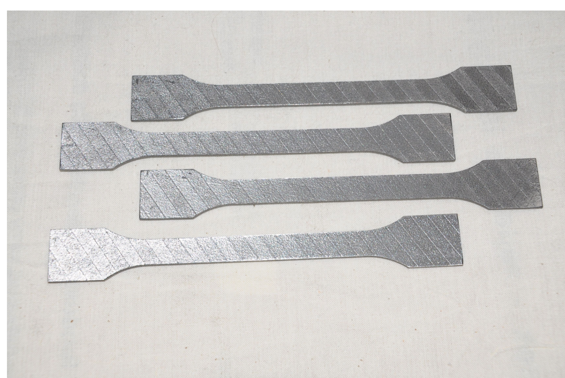
Rys. 5. Kształtki EOS-SLS do próby rozciągania Fig. 5. Fittings EOS-SLS to the tensile test
