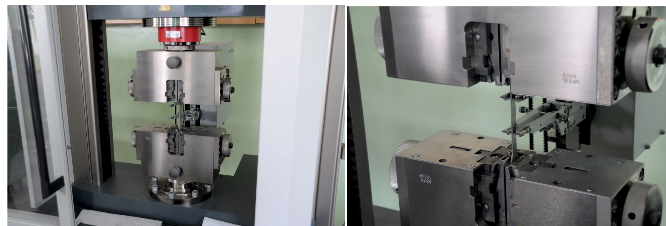
Rys. 6. Rozciąganie próbek ze stopu Ti6Al4V Fig. 6. Tensile samples of an alloy Ti6Al4V
