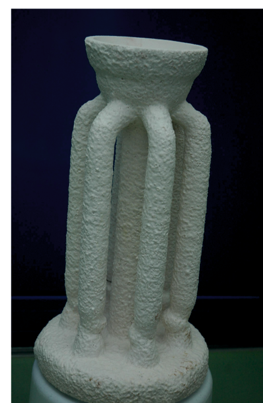
Rys. Forma ceramiczna po wypaleniu. Fig. Ceramic shell mould after the burning process.
