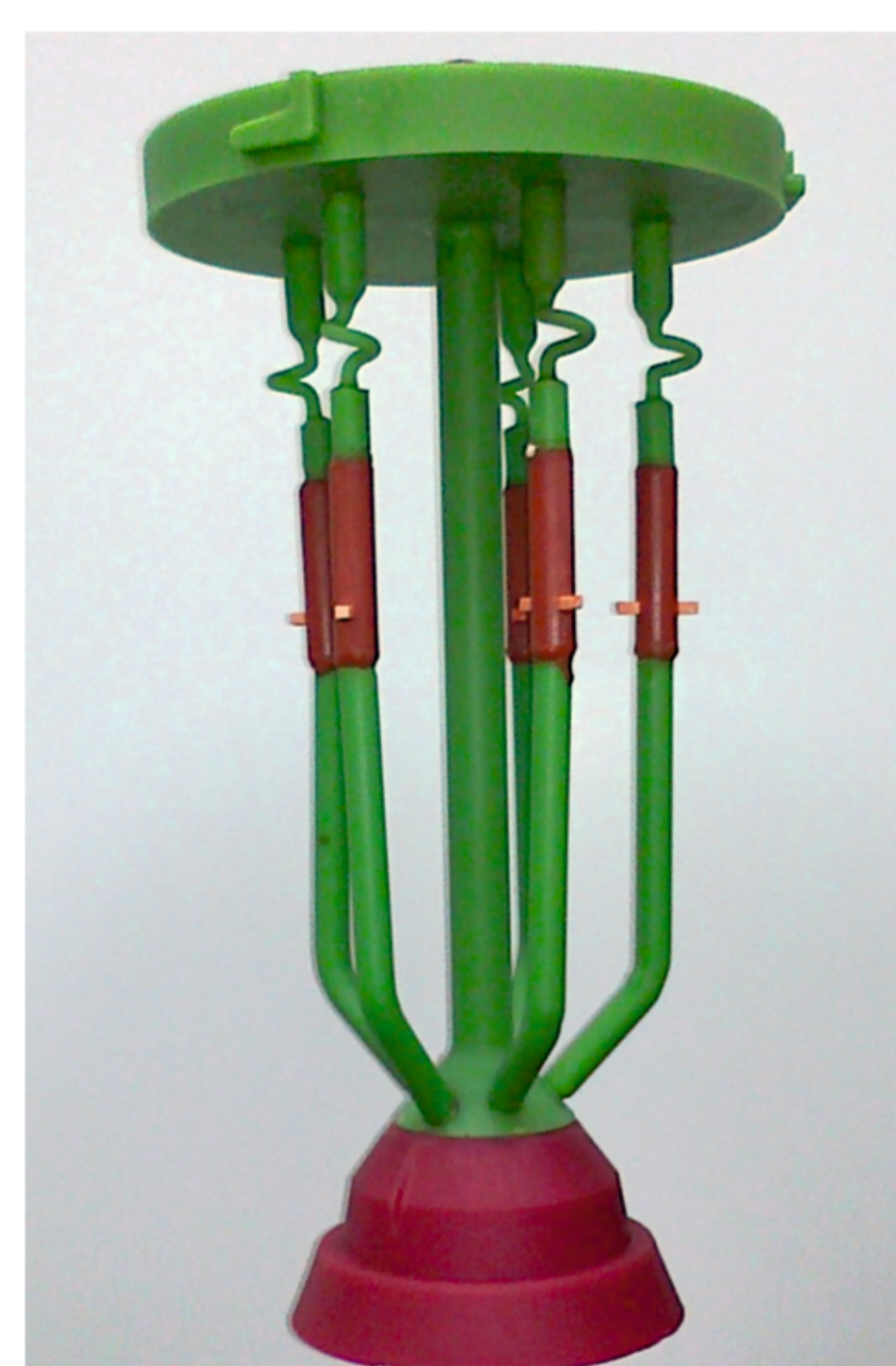
Rys. Woskowy zestaw modelowy. Fig. Wax model set.
