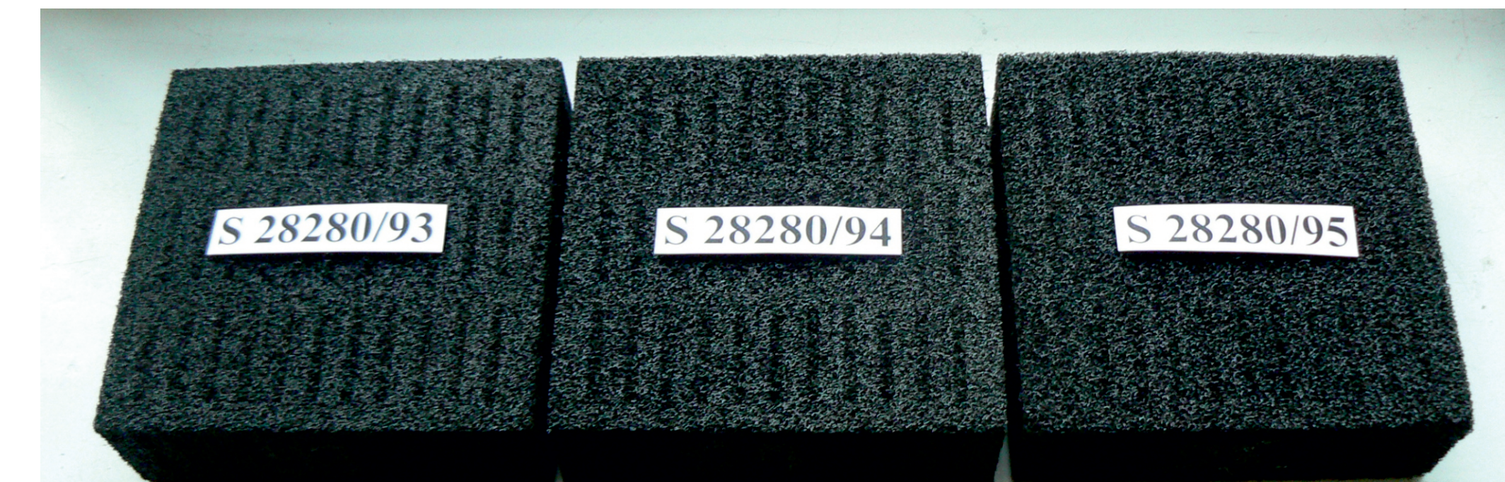
Rys. 2. Próbkę pianki auksetycznej 150x150x50 mm przetworzonej z pianki poliuretanowej S28280 245x245x82 mm (S28280/93), 216x216x72 mm (S28280/94) i 192x192x64 mm (S28280/95) Fig. 2. The auxetic foam specimens 150x150x50 mm made from S28280 polyuretan foam 245x245x82 mm (S28280/93), 216x216x72 mm (S28280/94) and 192x192x64 mm (S28280/95)
