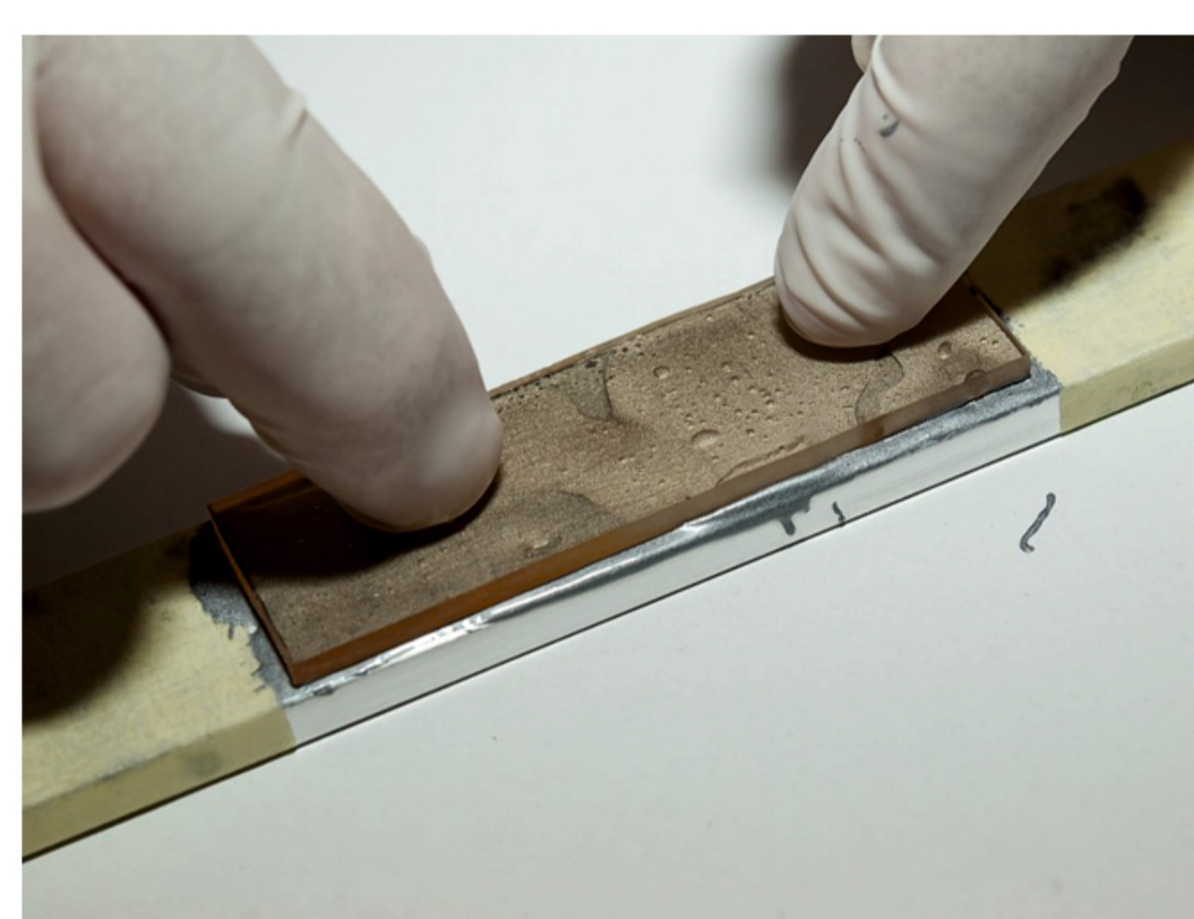
Rys. 9. Przygotowanie próbki do wyznaczenia stałej odkształceniowej Fig.9. Preparation of samples for the determination of deformation factor
