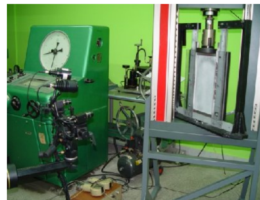
STANOWISKO DO BADAŃ DOŚWIADCZALNYCH ORAZ SKANER ARAMIS
