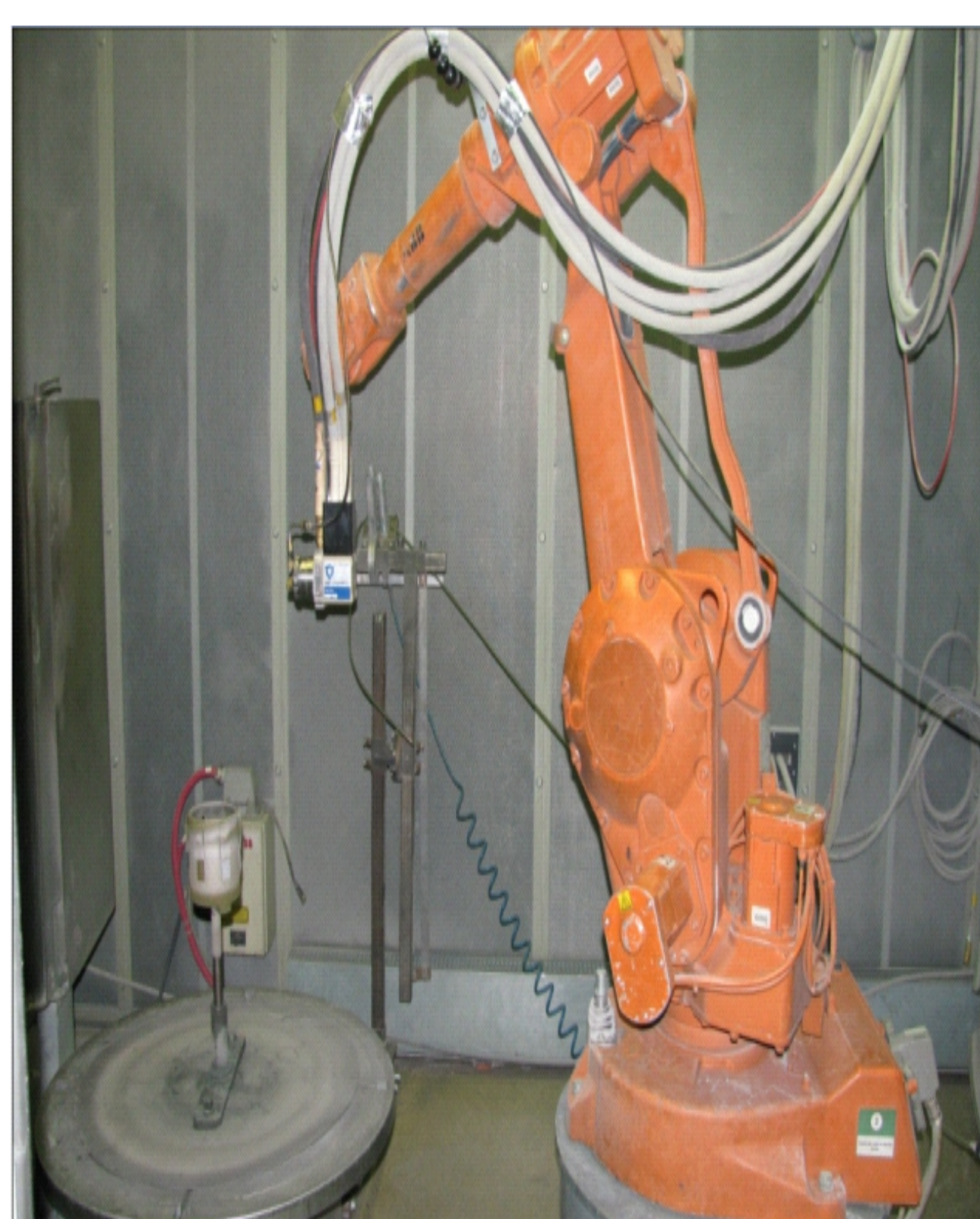
Robot sterujący procesem natryskiwania Robot control of thermal spraying process
