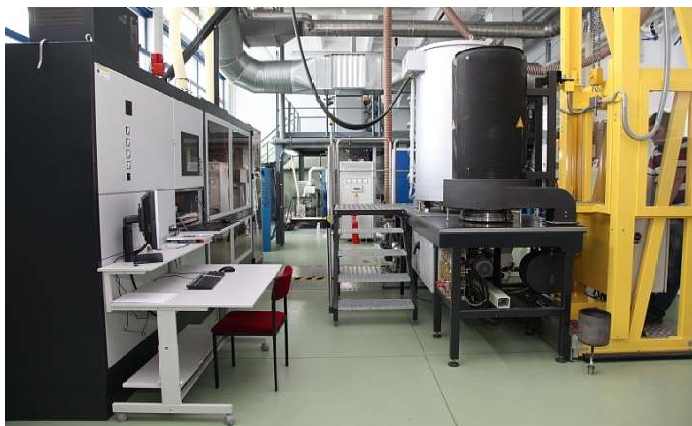
Urządzenie BXP Pro 325S do aluminizacji metodą CVD
