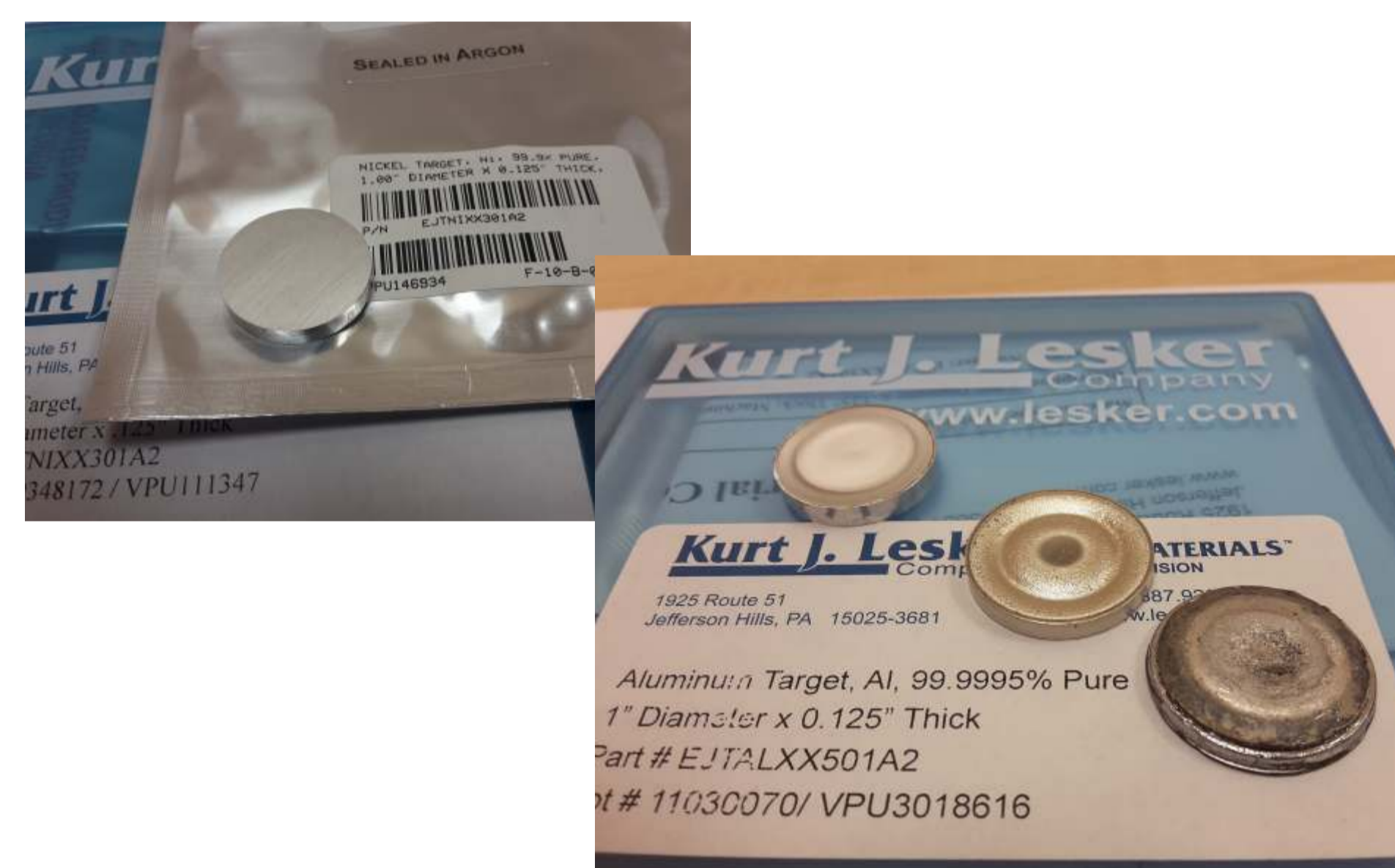
Rys.5. Targety użyte w procesie PVD Fig.5. The targets used in PVD process
