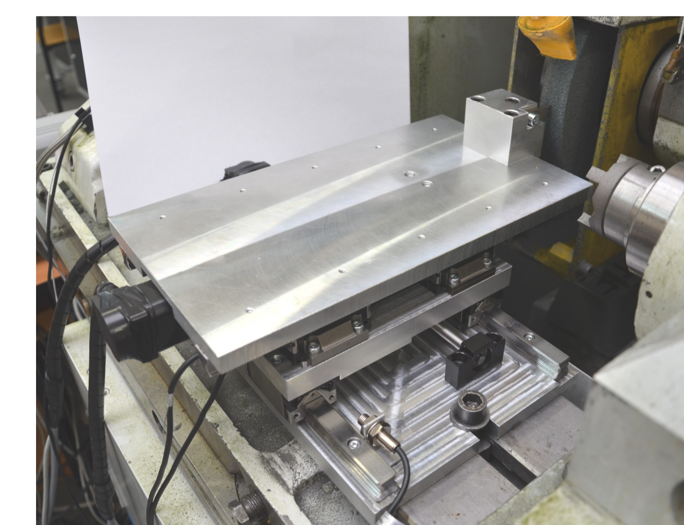
Rys. 7. Urządzenie do nadawania kształtu powierzchni czołowej ściernicy Fig. 7. Device for profiling of the grinding wheel
