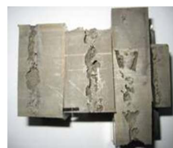
Przekrój osiowy wlewki wsadowego stopu niklu IN-713C. Axial section of the IN-713C nickel alloy master heat ingot
