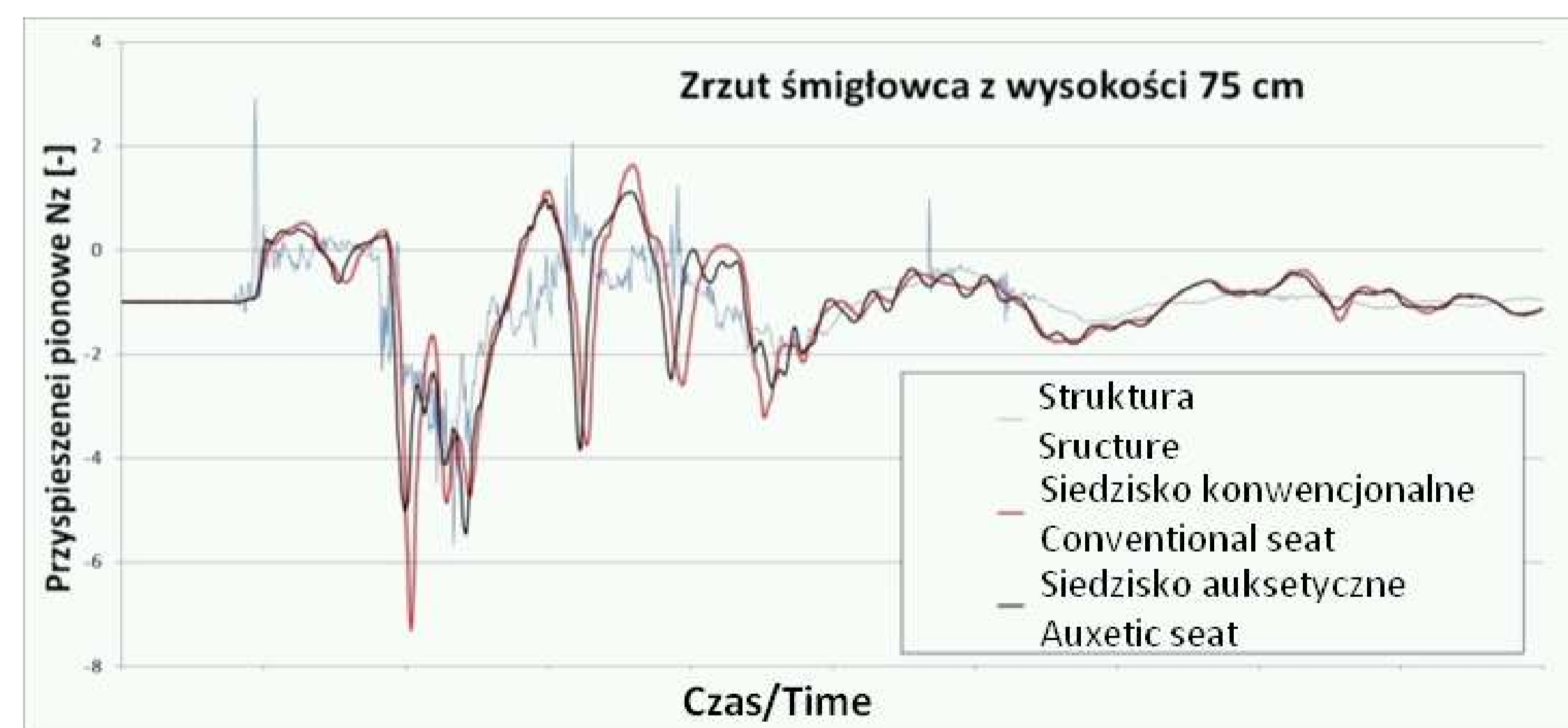
Wyniki pomiaru przyspieszenia podczas twardego lądowania - wysokość 75 cm. Results of deceleration measurements during harsh landing - 75 cm height.
