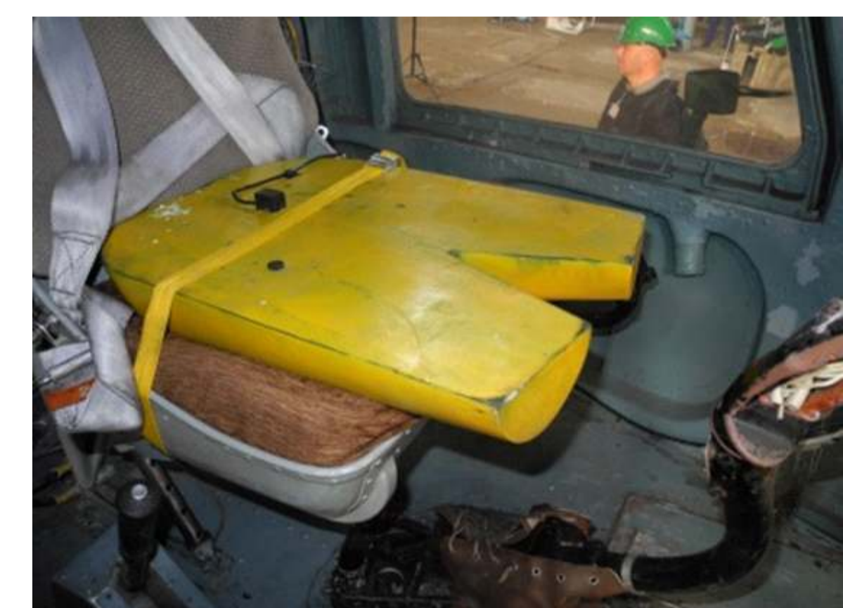
Wzrost RCLi o masie 78 kg z akcelerometrem na siedzisku z poduszką z pianki auksetycznej 78 kg RCLi indenter placed on a seat cushion in a helicopter seat and equipped with an accelerometer
