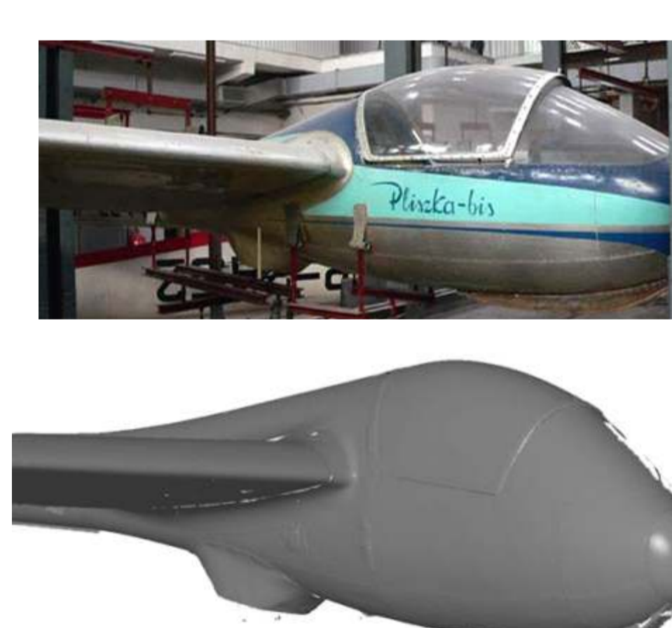
Rys.4. Porównanie rzeczywistej konstrukcji z wynikami pomiaru Fig.4. Comparison of actual construction and the measurement results
